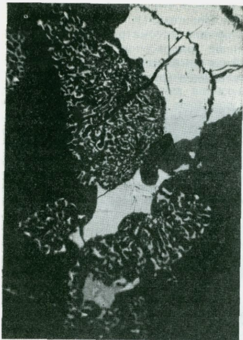
Рис. 8. Эвтектисидные сращения пирротина и пентландита с оливином в рудоносных оливиновых пироксенитах. Увел. 90, без анализатора. Чайское месторождение, участок Огиендо.
