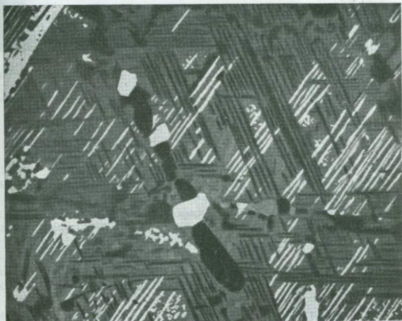
Рис. 9.9. Пластинки ильменита, образовавшиеся в результате распада твердого раствора и располагающиеся вдоль плоскостей (111) магнетита. Бёгсто, Норвегия (николи частично скрещены, ширина поля зрения 520 мкм).
