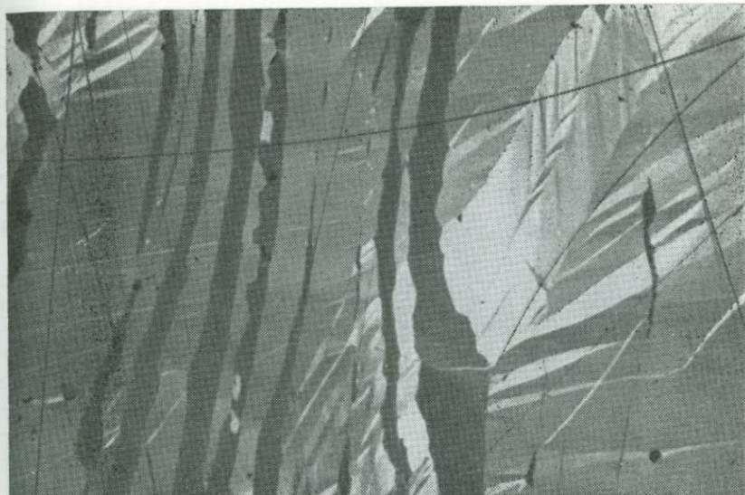
Рис. 7.18. Сложные пластинки давления, образовавшиеся в антимоните в результате деформации; большое разнообразие окрасок обусловлено различной кристаллографической ориентировкой пластинок. Никולי скрещены (ширина поля зрения 520 мкм).
