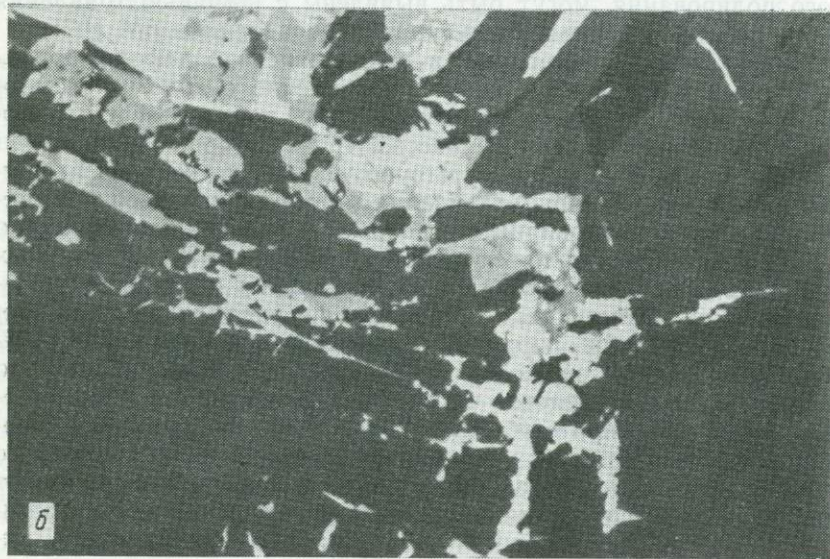
Рис. 10.23. Текстуры, наблюдаемые в метаморфизованных массивных сульфидах: a — сильная деформация и нарушение первичной полосчатости в переслаивающихся сфалерите (серое) и галените (белое). Маунт-Айза, Австралия (ширина поля зрения 8 см); б — халькопирит (белое) и сфалерит (светло-серое), внедрившиеся в раздробленные амфиболы. Грейт-Госсан-Лид, Виргиния (ширина поля зрения 700 мкм) (из Henry et al., Econ. Geol., 74, 651, 1979; использовано с разрешения); в — пирротин, инъецированный вдоль спайности в де-
