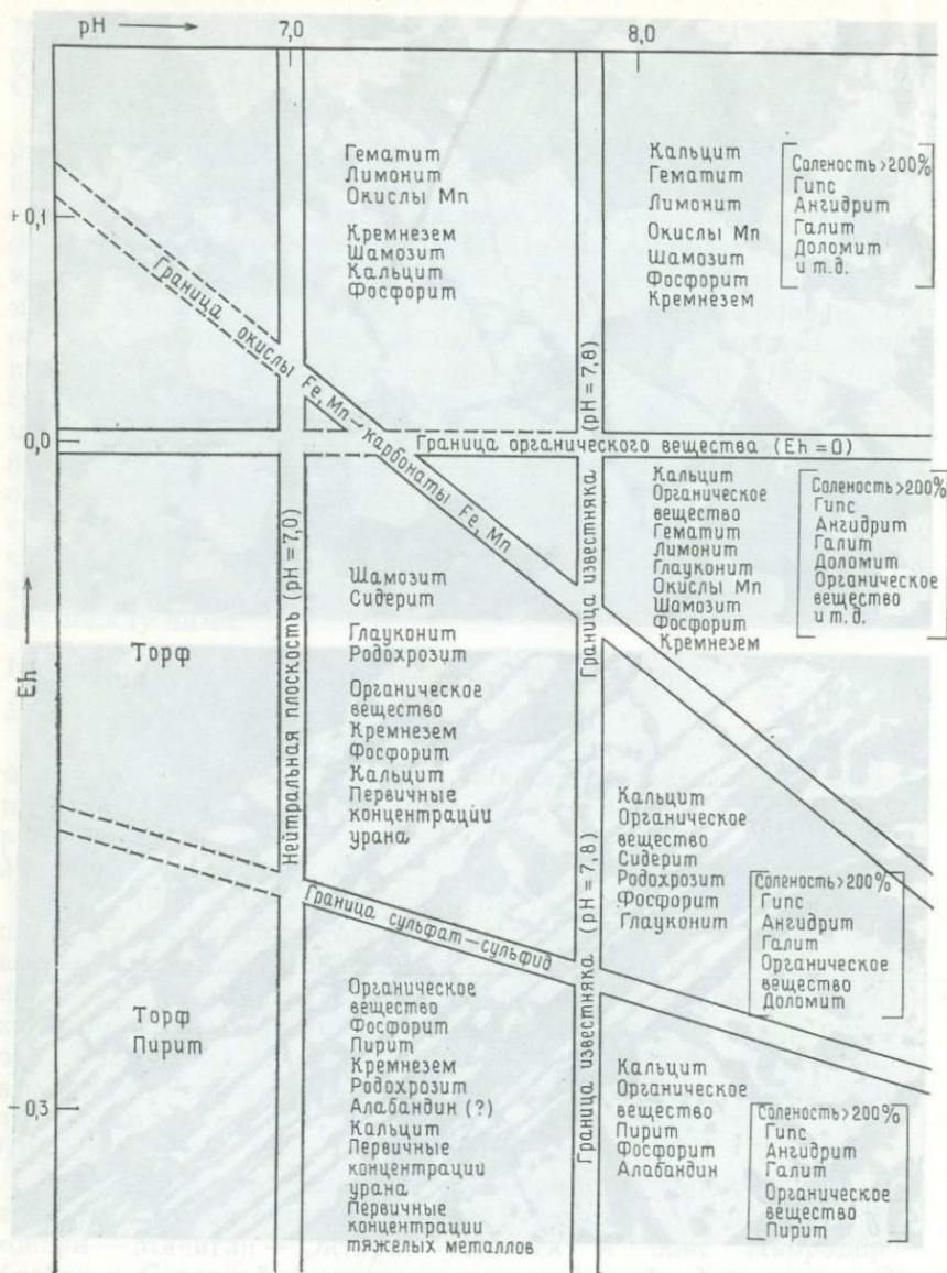
Рис. 10.3. Граничная диаграмма, показывающая Eh-pH-поля, в которых при нормальных морских условиях образуются конечные ассоциации минералов, важных для осадочных руд железа и других химических осадков. Под шамозитом здесь подразумеваются осадочные силикаты железа. Ассоциации, взятые в прямые скобки, относятся к растворам повышенной солености (соленость >200‰) ([7], воспроизведено с разрешения издательства Чикагского университета).
