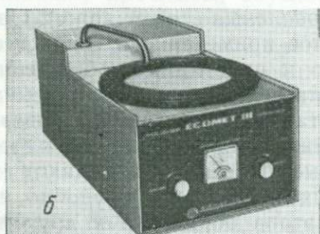
Рис. 2.1. Примеры выпускаемых промышленностью различных типов оборудования, предназначенного для изготовления полированных шлифов: а — большой автоматический шлифовально-полировальный станок Dügener для одновременного изготовления нескольких шлифов; б — ручной шлифовально-полировальный станок с меняющейся скоростью, Buehler № 49-1650 Ecomet III; в — малый автоматический шлифовально-полировальный станок для изготовления 1—3 шлифов одновременно, Engis MK2a; г — синхронный электромагнитный вибрационный полировальный станок, FMC Corporation (воспроизведено с любезного разрешения фирм).
