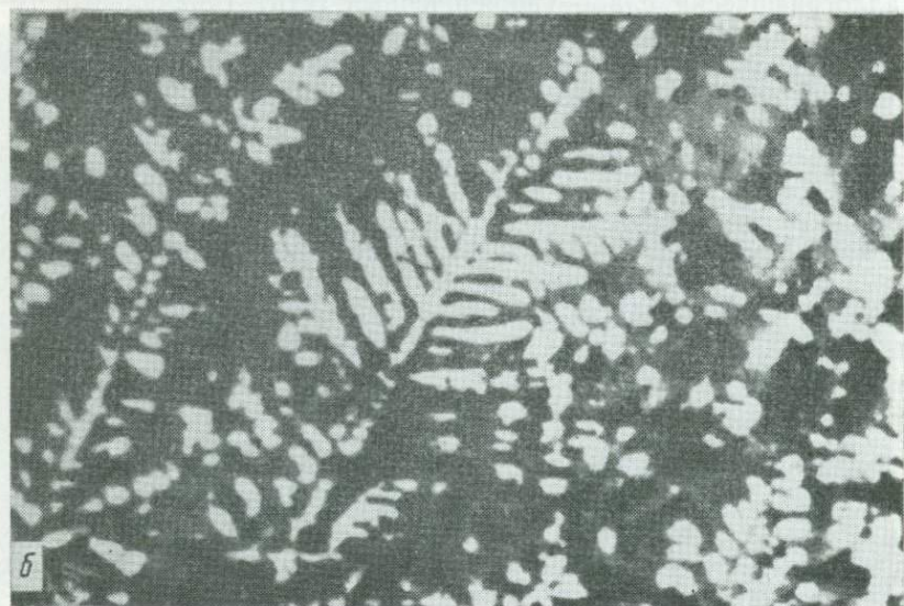
Рис. 11.6. a — сферические выделения железа в шлаке сталелитейного производства (ширина поля зрения 520 мкм) (образец получен благодаря любезности Бетлехемской стальной корпорации); б — дендритовые кристаллы магнетита в основной массе стекла; агломерат железной руды Асуана (ширина поля зрения 200 мкм) (по Баста и др. [2], с разрешения авторов); в — медно-никелевый штейн с мелкими идиоморфными кристалликами дисульфида железа и никеля в основной массе \text{Cu}_2\text{S} (темно-серое) и \text{NiS} (светло-серое). В верхнем левом углу видно крупное гипидиоморфное зерно металлического никеля (ширина поля зрения 2000 мкм).
