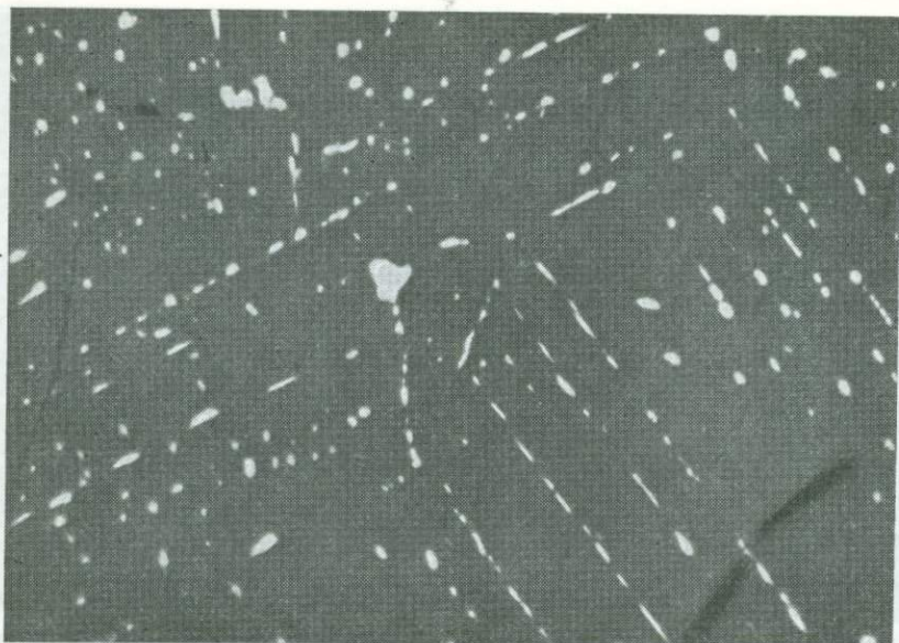
Рис. 7.15. Зерна и жгутики халькопирита, ориентированные в сфалерите. Эта ассоциация часто интерпретировалась как результат распада твердого раствора, но экспериментальные исследования показали, что сфалерит не может растворять достаточное количество меди для образования такой структуры распада (см. текст), Грейт-Госсан-Лид, Виргиния (ширина поля зрения 520 мкм).
