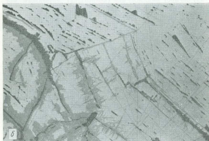
Рис. 7.10. a — ковеллин, замещающий халькопирит (белое) вдоль границ зерен, Грейт-Госсан-Лид, Виргиния (ширина поля зрения 520 мкм); б — халькозин (серое), замещающий галенит (светло-серое) вдоль границ зерен и спайности, Алдерли-Эдж, Чешир, Англия (ширина поля зрения 500 мкм); в — галенит (белое), замещенный церусситом ( PbCO_3 , светло-серое) по краям первоначального зерна, Северо-Пеннинское рудное поле, Англия (ширина поля зрения 500 мкм); г — тонкозернистый пирит и марказит (белое), псевдоморфно замещающие удлиненные кристаллы пирротина. Реликты пирротина (po) сохраняются в центральных частях этих псевдоморфоз. Сфалерит (sl) и сиде-
