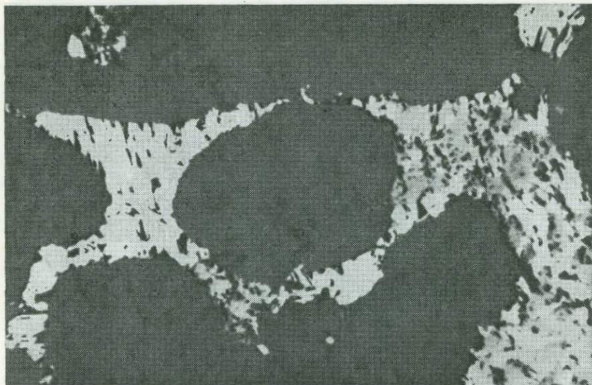
Рис. 10.14. Галенит (светло-серое) и сфалерит (серое), заполняющие промежутки между зернами кварца. Лайсвалль, Швеция (ширина поля зрения 2000 мкм).
