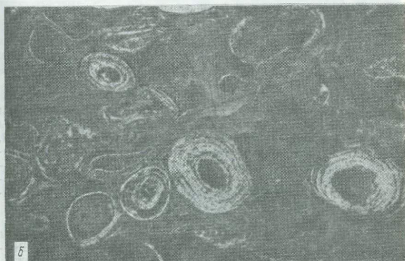
Рис. 10.1. Структуры, наблюдаемые в типичных бурых железняках: а — деформированные оолиты, состоящие из тонкозернистых шамозита, гематита и гётита. Формация Ред-Маунтин, Алабама; б — оолиты шамозита и гётита. Роздейл, Северная Англия (ширина поля зрения на обоих снимках 2000 мкм).
