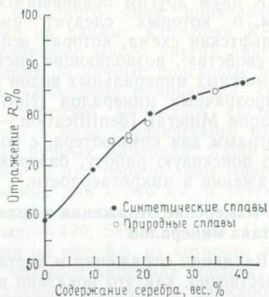
Рис. 5.11. Расположение составов искусственных золото-серебряных сплавов на диаграмме отражение (при \lambda=550 нм) — содержание серебра [23].
