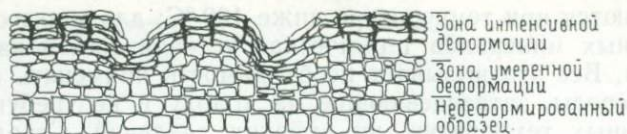
Рис. 2.3. Схематический разрез поликристаллического образца, показывающий характер деформации от поверхности среза в направлении к недеформированной части. Характер и глубина деформации зависят от природы образца.
