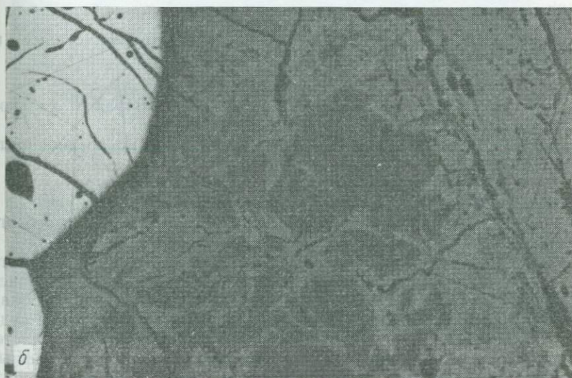
Рис. 9.26. Типичные руды медно-цинково-мышьяковой формации: а — крупнозернистый агрегат ковеллина (серое) с прожилками более позднего халькозина. Бьютт, Монтана (ширина поля зрения 2000 мкм); б — участки борнита в халькозине с расположенными по флангам энаргитом (справа) и пиритом (белое). Бьютт, Монтана (ширина поля зрения 2000 мкм).
