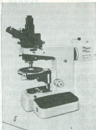
Рис. 1.1. Типичные модели микроскопов, используемые в рудной микроскопии (приводятся с любезного разрешения фирм): а — универсальный исследовательский микроскоп фирмы Opton; б — микроскоп Orthoplan-Pol фирмы Leitz; в — микроскоп Orthiphot-Pol фирмы Nikon; г — микроскоп M12a с приставкой для определения микротвердости фирмы Vickers.
