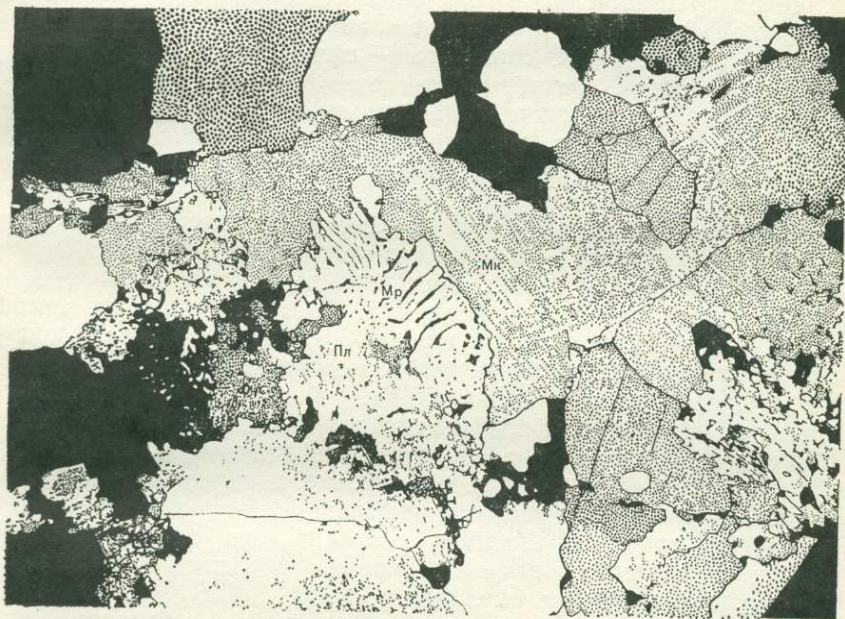
Рис. 36. Гранит с гипидиоморфнозернистой структурой. Ув. 20; николи +. Мирмекитовый агрегат (Мр) в микрoклинe (Мк) на границе с плагноклазоm (Пл).
