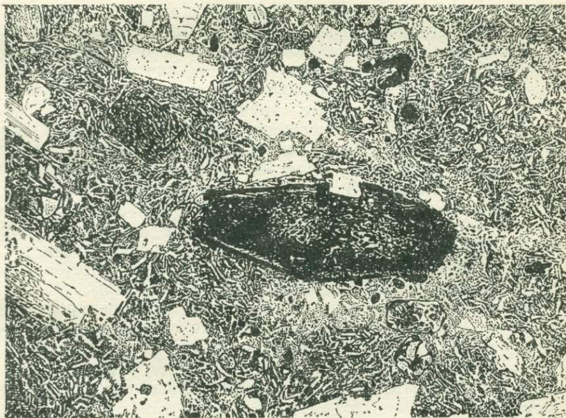
Рис. 35. Андезитовая структура в роговообманковом андезите. Ув. 40; при одном николе
