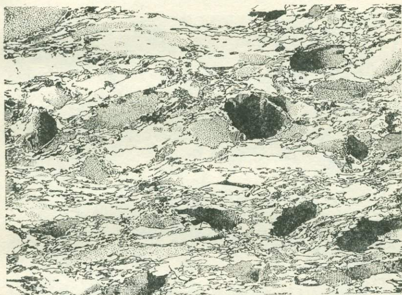
Рис. 70. Блестосаммитовая структура и сланцеватая текстура в кварците. Кокчетавский массив, Центральный Казахстан. Ув. 20; николи +.
