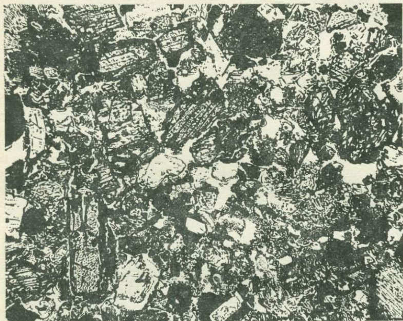
Рис. 61. Кристаллокластическая структура в зернистом туфе андезитов. Ув. 46; при одном николе.
