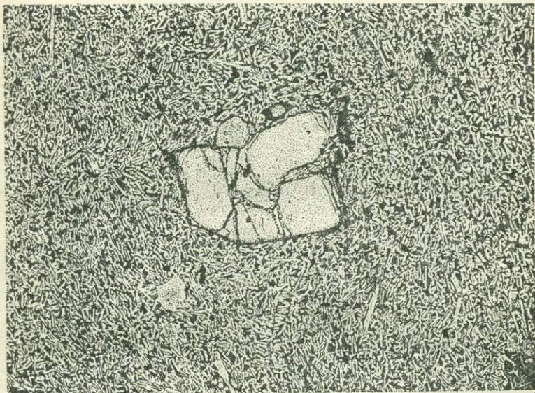
Рис. 7. Порфировая структура в оливиновом базальте с полукристаллической основной массой. Закарпатье. Ув. 20; при одном никеле.
