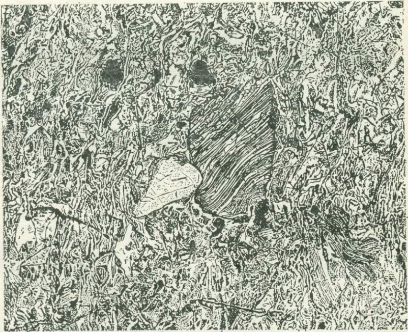
Рис. 60. Витрокластическая структура в зернистом туфе липаритов. Ув. 70; при одном никеле.
