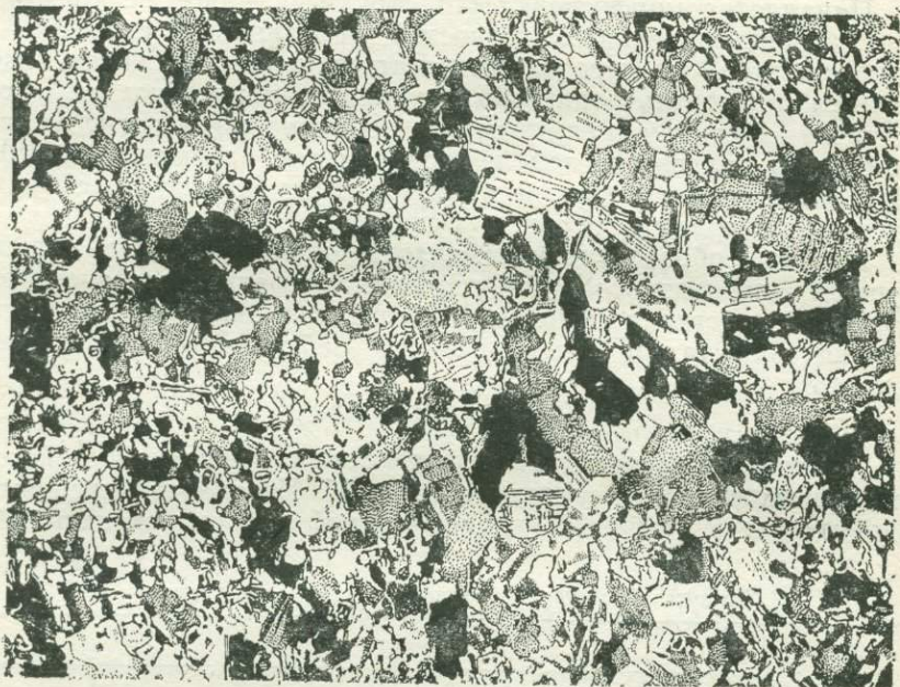
Рис. 48. Паналлотриоморфнозернистая структура и гнейсовидная текстура в миаските с широким развитием лейстового альбита. Ув. 30; николи +.
