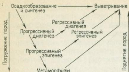
Рис. 26. Схема возможных вариантов преобразования осадков и осадочных пород при литогенезе
