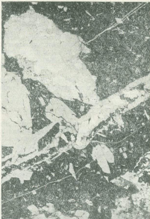
Рис. 3. Ксенолит кварца с касситеритом в хлоритизированном порфирите. Хлорит замещает порфиновые вкрапленники в дайке и частично кварц ксенолита около хлоритового прожилка с кварцем поздней генерации и сфалеритом. В нижней части — контакт с рудной жилой. Фото шлифа, увел. 9
