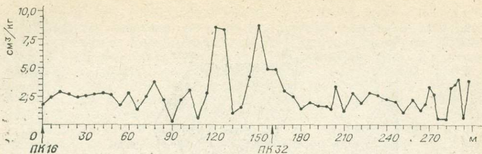
Рис. 5. Распределение эндогенной \text{CO}_2 в гранитах по данным опробования горизонтальной выработки разведочной шахты.
