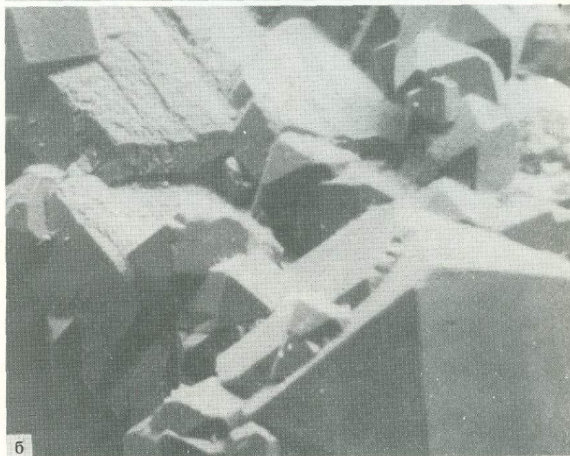
Электронно-микроскопические снимки минералов а — гнездовый криолит; интенсивно деформированная поверхность; увел. 7000; б — нарастание кубооктаэдрических кристаллов ральстонита на призматические кристаллы томсенолита; увел. 450
