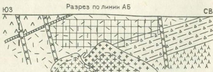
Рис. 2. Схематическая геологическая карта и разрез Джанкетовского месторождения. По Г.И. Бедрову и Р.Н. Мальновой.
