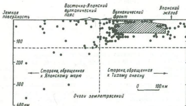
Рис. 18. Расположение очагов землетрясений под Японским глубоководным жёлобом (Сугимура, 1970).
