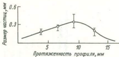
Рис. 4.2. Распределение микрокристалликов по граням кристалла кварцов. (Подсчет кристалликов осуществлялся на грани \{111\} , нормально ориентированной к потоку: эксп. 1-10).
