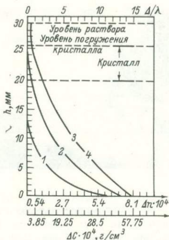
Рис. 3.5. Кривые распределения концентрации по высоте столба раствора, построенные по интерферограммам рис. 3.4.
