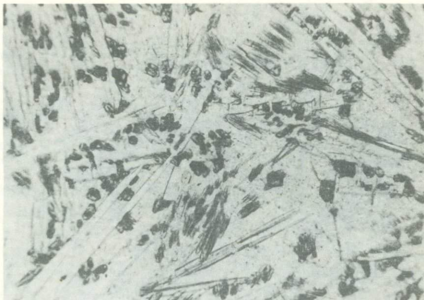
Рис. 8. Структура образца 10 – 3 F. Крупные таблитчатые кристаллы выделения пироксена в стекле. Николи –, ув. 50
