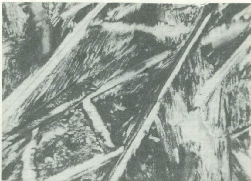
Рис. 4. Крупнотаблитчатые кристаллы плагиоклаза I генерации, в промежутках — мелкие короткопризматические выделения пироксена в сростании с игольчатыми кристаллами плагиоклаза II генерации в стекле
