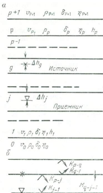
Рис. 31. Схема строения многослойной среды (а) и двухслойной эквивалентная модель (б), используемая для определения частотной характеристики
