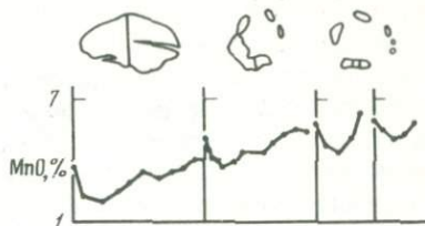
Рис. 41. Кривые распределения компонента, рассчитанные по 1-ой модели Е. Андерсена и Г. Бакли (1973 г.) при условии диффузии компонента внутрь кристалла (а) или во внешнюю среду (б)
