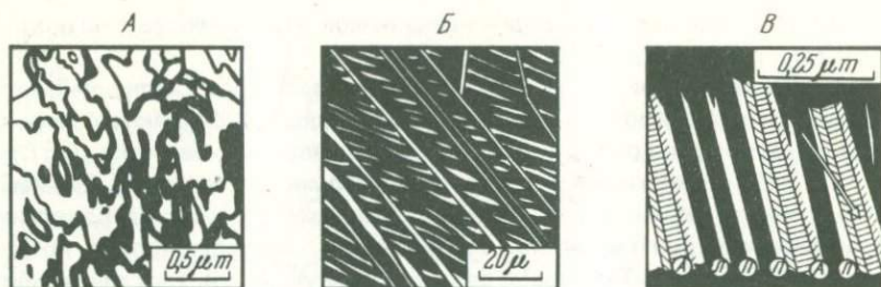
Рис. 4. Тонкое (доменное и ламеллярное) строение полевых шпатов [23].
