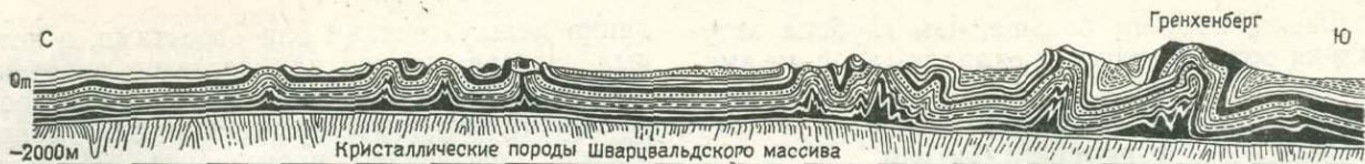
Рис. 238. Разрез через Юрские горы [Buxtorf, 1916] — пример дисгармоничной складчатости, связанной с общим отрывом от фундамента
