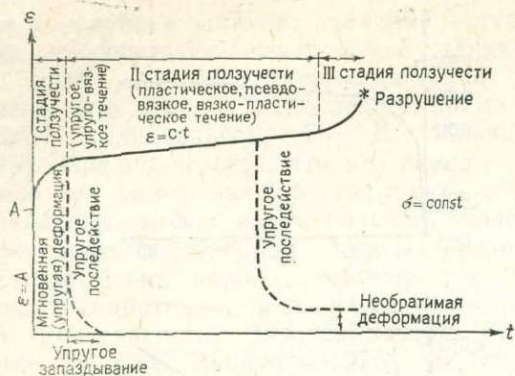
Рис. 53. Обобщенная (типичная) кривая ползучести
