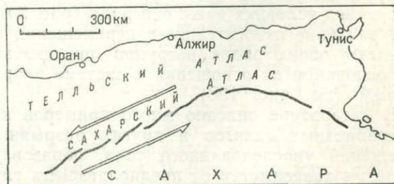
Рис. 200. Типичный ряд кулисообразных сдвигов на сочленении Сахарской плиты и гор Атлас. Стрелками показано направление глубинного сдвигового перемещения в период образования кулисообразных сдвигов (см. рис. 161), в интерпретации автора
