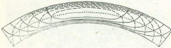
Рис. 244. Траектории сжимающих \sigma_1 (сплошные линии) и растягивающих \sigma_3 (пунктирные линии) напряжений в упругой пластине, подвергающейся время от времени изгибанию на концах [Schmidt, 1932, с дополнениями]. Траектории напряжения \sigma_2 перпендикулярны к плоскости рисунка. Точечная линия — нейтральная поверхность
