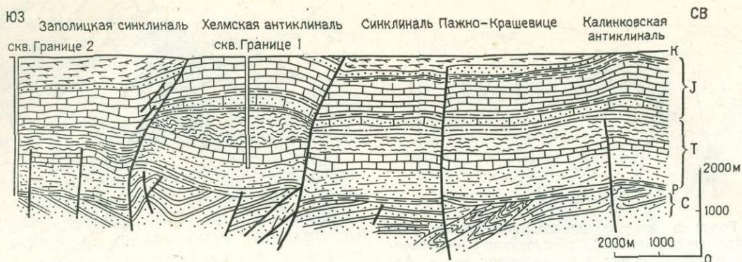
Рис. 317. Часть разреза через Радомсковское поднятие [Pozaryski, 1971] — пример складчато-сбросовой тектоники
