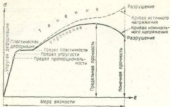
Рис. 25. График зависимости между напряжением \sigma и деформацией \epsilon стержня из низкоуглеродистой стали, подвергающегося одноосному растяжению
