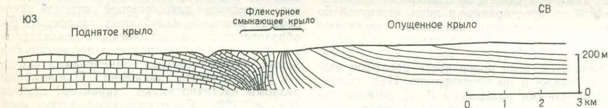
Рис. 209. Элементы флексуры (разрез через флексуру в районе Сенно в Свентокишских горах) [Pożaryski, 1948]. Поднятое крыло — юра, опущенное крыло — мел
