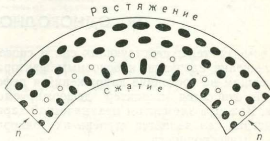
Рис. 8. Система напряжений в изгибаемом слое, представленная с помощью эллипсов, образовавшихся вследствие деформации шаров, вписанных в слой до изгиба. Рисунок получен на основании экспериментальных данных, n — нейтральная поверхность
