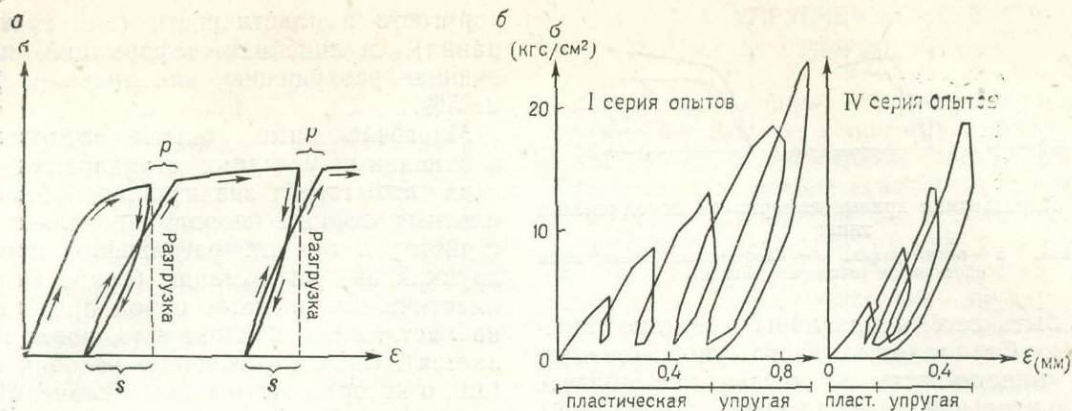
Рис. 26. Кривые упругого гистерезиса функции \sigma/\epsilon :
