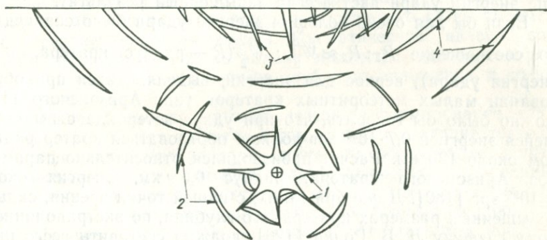
Рис. 36. Система трещин в горных породах при взрыве заряда [117]. трещины: 1 — радиальные, 2 — кольцевые, 3 — разлома, 4 — откольные.
