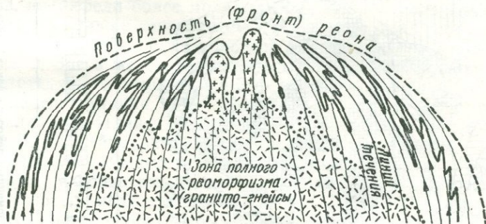
Рис. 1. Схема формирования гнейсового складчатого овала, по Л. И. Салоу [132].
