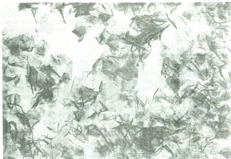
Р и с. 4. Электронно-микроскопическая фотография листочков бёрнессита из Чиа-турского месторождения в Грузии
