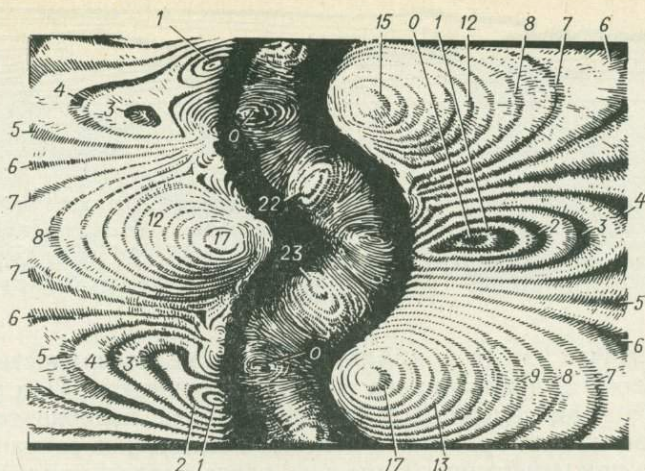
Рис. 13-4. Изохроматические полосы, образовавшиеся при продольном изгибе резиновых полос, погруженных в желатин.
