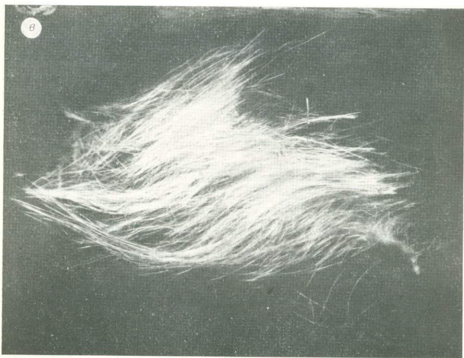
4 раза; в — спутанноволокнистый агрегат нитевидных кристаллов амфибол-асбеста, выращенных из гидротермальных высококонцентрированных растворов, увелич. 10 раз.
