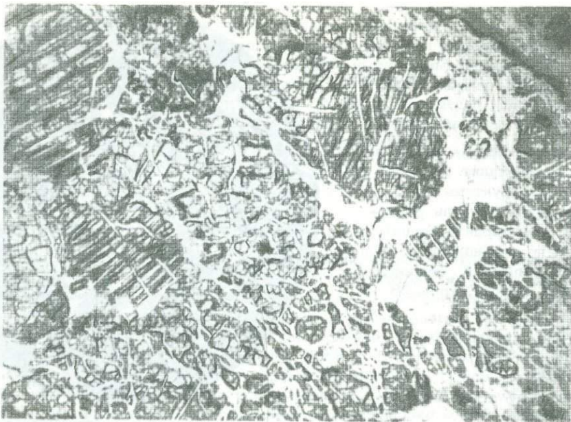
Фиг. 3. Хризотилизированный гарцбургит мелкосетчатой структуры Хризотил (белое) развивается по сети трещин в оливине и энстатите (зерна со спайностью). Останинское месторождение хризотил-асбеста. Без анализатора, увел. 28
