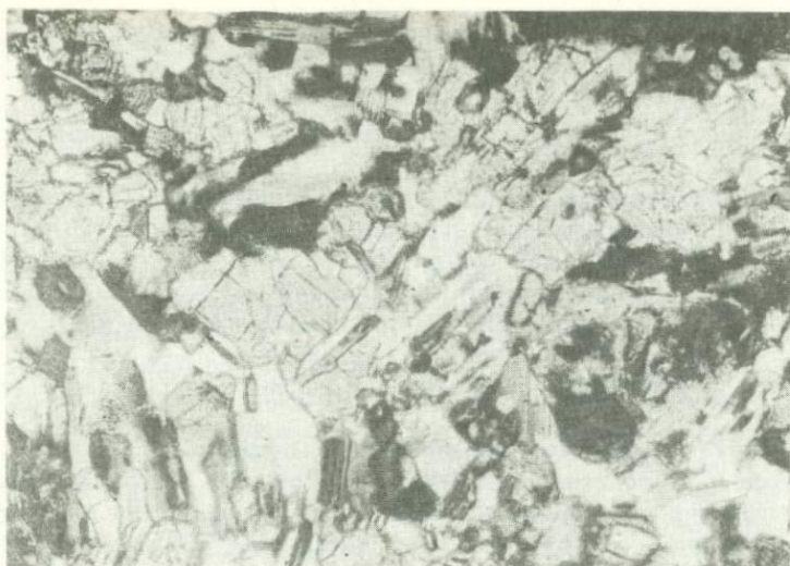
Рис. 14, Типичная структура эндоконтактовых норитов. Микрофото, шл. 935/92, ув. 50, николи х.
