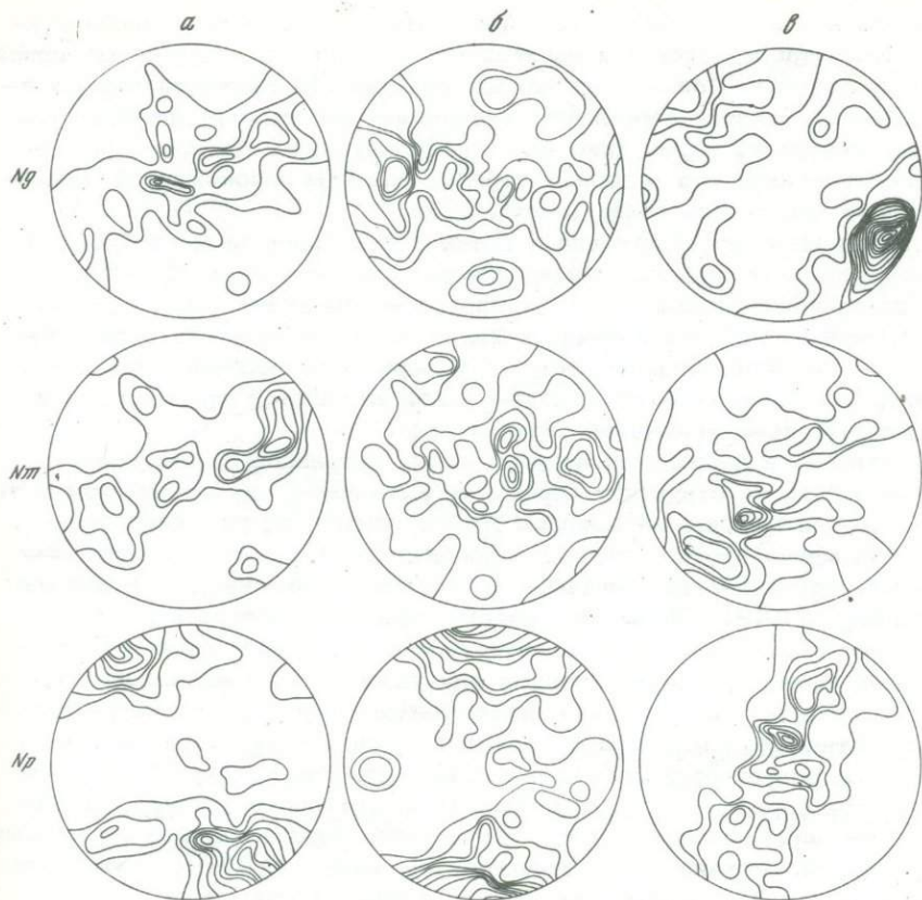
Рис. 20. Диаграмма ориентировки оптических направлений N_g, N_m, N_p оливина в перцолитовых включениях из базальтов: а - вулкана в долине р. Бартой (Западное Забайкалье); б - жерловины (?) в верховье р. Чукчуду (Удоканский хребет); в - оливина в перцолите из выбросов вулкана Авачинская Сопка (Камчатка). Данные по 120 зернам для каждого шлифа; изолинии соответствуют 1,2,3,... 15%
