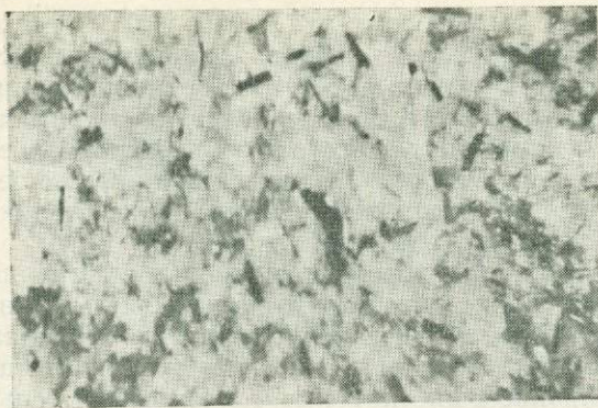
Рис. 1. Передовая зона колонки 1, отвечающая по составу рибекитовому граниту. Исходная порода — биотитовый гранит, воздействующий раствор — 1,0 NaF. Фото под бинокуляром, увел. 15
