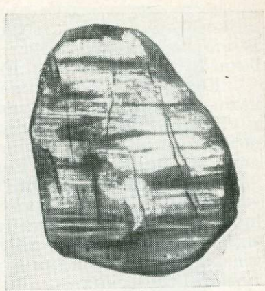
Рис. 181. Штуф колчеданной руды с горизонтальными бороздами на пирите, определяющими сдвиговое движение в интерминерализационную фазу, предшествующую отложению более поздней генерации (сфалерит, галенит). Мало-Учалинское месторождение
