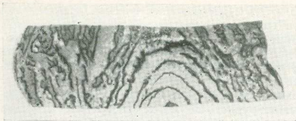
Рис. 124. Керн мигматизированной покровной породы плейчато-го сложения, встреченной глубокой скважиной на Пластовской площади рудного поля
