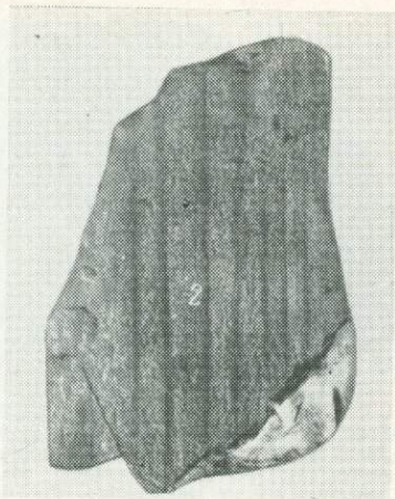
Рис. 97. Борозды движения в интэрминерализационной трещине, покрытые ненарушенными кристаллами кальцита, что устанавливает отсутствие последующих подвижек и проникновения рудных растворов. Жила 4, забой 185 на 6-м горизонте. Берикюль
