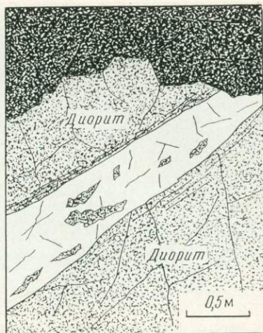
Рис. 8. Рудная жила перед полным затуханием вмещающей трещины (через 10—15 м) в диорите. Ксенолиты его в жиле угловатые, неизменены, расщановка стенок, как и подвигка, незначительна. Сульфиды отсутствуют, золотоносность кварца-следы. Троицкая жила месторождения Степняк, конечный забой штрека на горизонте 210 м. Рисунок-копия по фото
