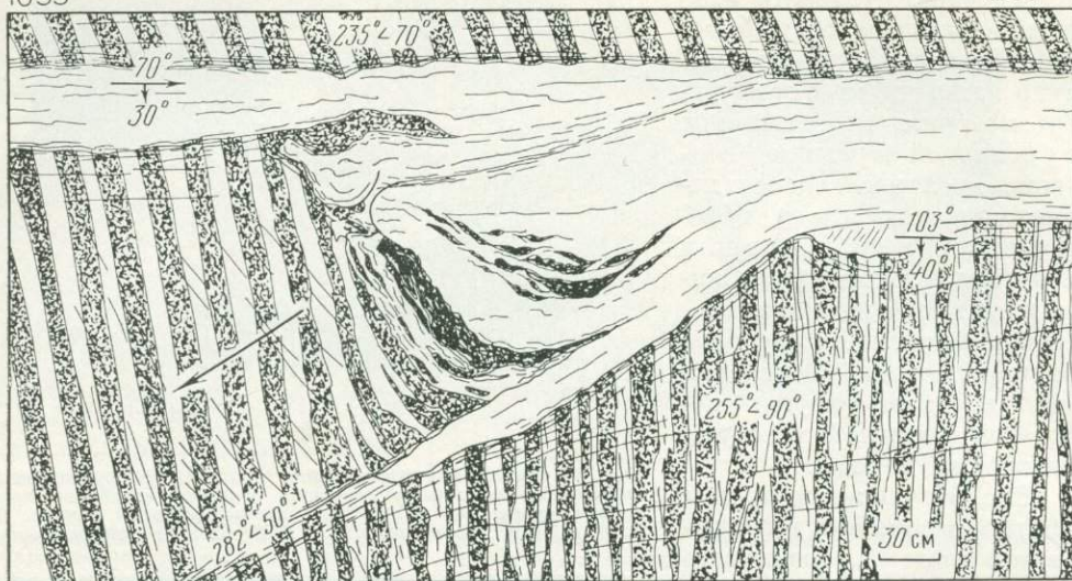
Рис. 49. Утолщение рудной жилы при косом сопряжении двух дорудных трещин в результате просадки углового клина вниз. Жила 1, горизонт 75 м, шахта 2, Центральный участок Бестюбе
