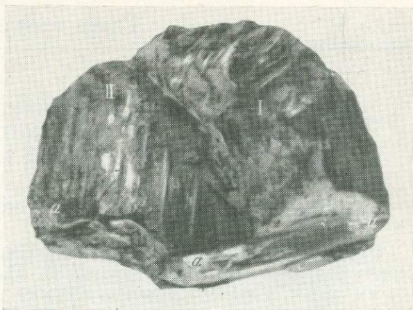
Рис. 100. Внутрирудные борозды скольжения, обнаруженные расколом по сульфидному шву (а—а) после разъема вмещающих слоев I—II. Жилы 4 при скрещении с жилой Крутой на 6-м горизонте. Берикюль
