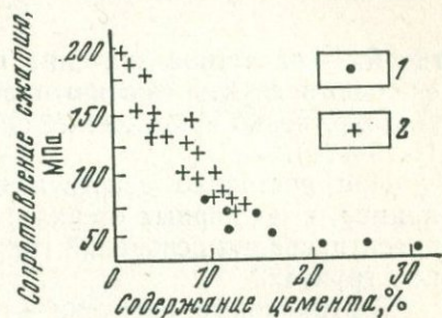
Рис. 6. Влияние состава и содержания цемента на прочность песчаников при сжатии. По Б. В. Залескому и Ю. А. Розанову: 1 — железисто-глинисто-серицитовый цемент; 2 — кварцево-серицитовый цемент
