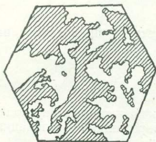
Рис. 118. Разрез дофинеи-ского двойника кварца
