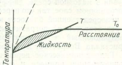
Рис. 85. Схема возникновения концентрационного переохлаждения в слое толщиной \delta перед плоским фронтом кристаллизации
