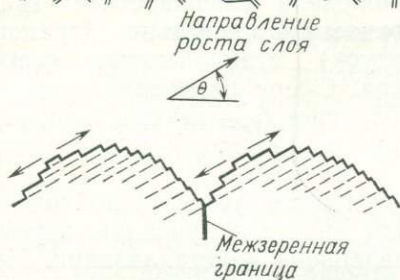
Рис. 96. Ячеистая структура поверхности раздела кристалл — расплав (каждая ячейка имеет свою слоистую структуру)
