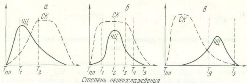
Рис. 27. Три этапа расположения взаимно независимых кривой числа центров кристаллизации и кривой скорости кристаллизации в различных переохлажденных системах
