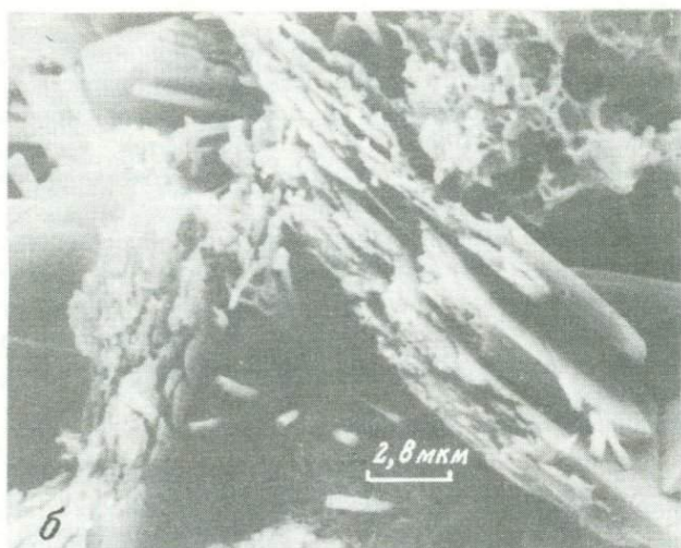
Р и с. 3. Электронномикроскопические снимки структур золоцементогрунтовых систем на основе аллювиального мелкозернистого песка
