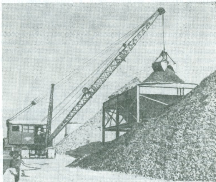
Р и с. 14. Выгрузка устричных раковин с баржи. Для получения негашеной извести раковины промывают и обжигают; полученный продукт подвергают гашению и используют для осаждения магния из морской воды. Разработка залежей раковин ведется в заливах Галвестон и Матагорда.
