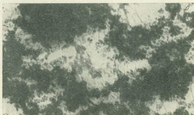
Рис. 14. Структуры свежесажженной гидроокиси железа (а), гидроокиси железа, окристаллизованной по типу гидрогетита (б), и окиси железа (в) ( \times 40\ 000 )
