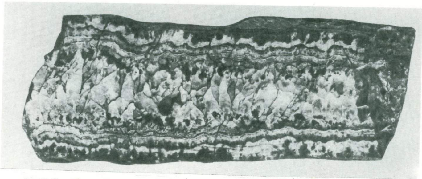
Рис. 24. Кварц-касситеритовая жила симметрично-полосчатой текстуры; в зальбандах фистончатые агрегаты коллоидного касситерита (фото Т.В. Забариной) . 1/2 натур. вел.
