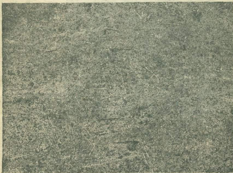
Рис. 38. Поверхность туфа, полученная распиловкой на дисковых станках.
