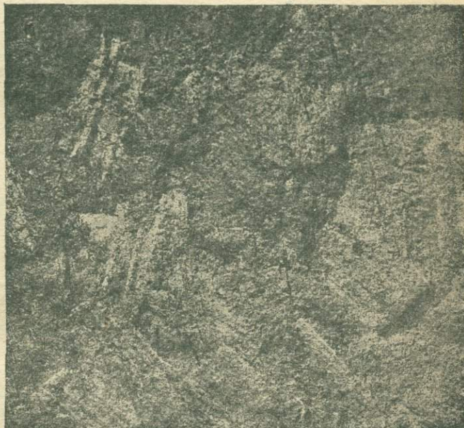
Рис. 40. Поверхность туфа обработки пневматическими молотками.
