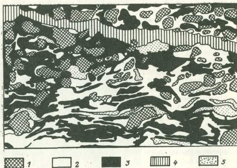
Рис. 8. Зарисовка части слоя серого слоистого боксита. Обр. 193-68, x 7. СУБР, Кальинское месторождение
