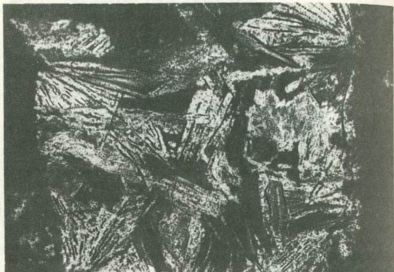
Рис. 45. Лучистый кианит из серых бокситов. Шлиф 326, без анализатора, \times 100 . Тотинское месторождение
