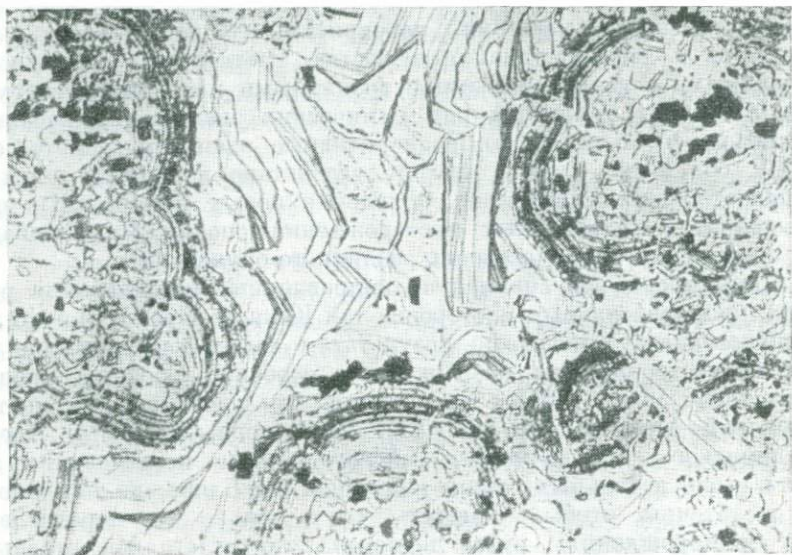
41. Реликты колломорфных структур пирита; черное — пустотки. Южное месторождение (Карабаш). Отраженный свет, протравлено, увел. 35
