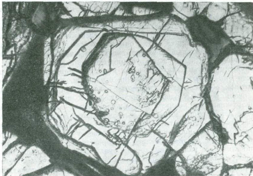
90. Рекристаллизация трещиноватого пирита. Тарньерское месторождение. Отраженный свет, протравлено, увел. 25
