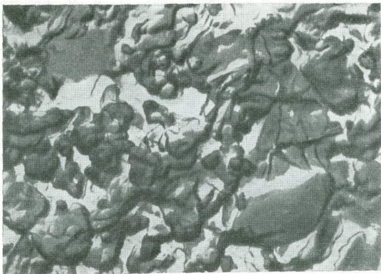
1. Строение тонкодисперсной (землистой) руды. Реплика со скола. Блявинское месторождение, увел. 24 000
