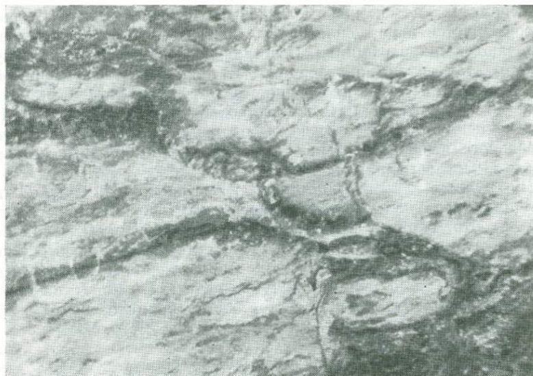
87. Развитие прозрачного серицита (темное) по трещинкам в замутненном серебристо-белом (светлое). Месторождение им. III Интернационала. Полированный шлиф. Снято под бинокуляром, увел. 30
