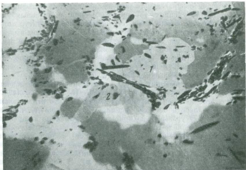
116. Наложение турмалина (черные продолговатые зерна) на медноколчеданную руду. Борнит-теннантитовая жила (Карабаш). Отраженный свет, увел. 100
