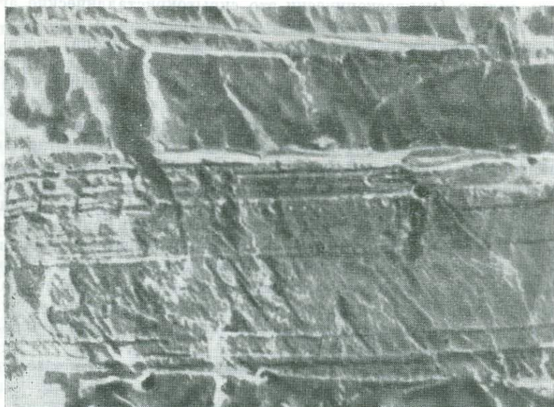
69. Скол деформированного зерна сфалерита. Видны многочисленные линии скольжения. Месторождение им. III Интернационала. Фото под электронным микроскопом, увел. 6380
