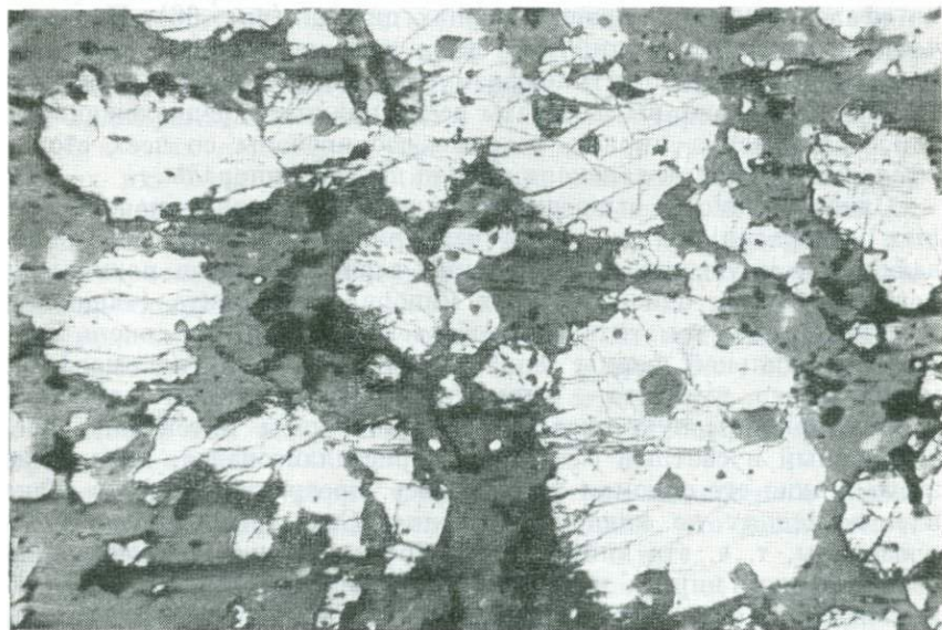
66. Выделения халькопирита в трещинках, пересекающих зерна пирита. Месторождение им. III Интернационала. Отраженный свет, увел. 70
