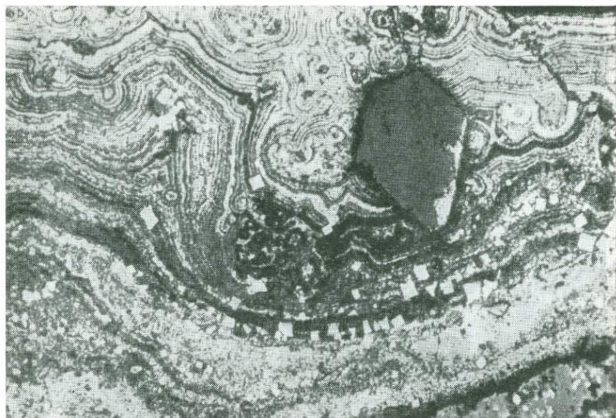
13. Сложный узор колломорфных структур пирита. Сибайское месторождение. Отраженный свет, протравлено, увел. 200 Белые и идиоморфные зерна — переотложенный пирит, черное (идиоморфное зерно) — кварц, серое (нижний правый угол фото) — сфалерит
