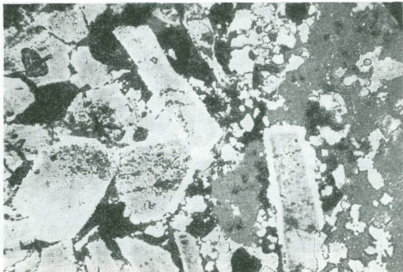
30. Пластинчатые выделения марказита пористые внутри и однородные по периферии. Комсомольское месторождение. Отраженный свет, увел. 340
