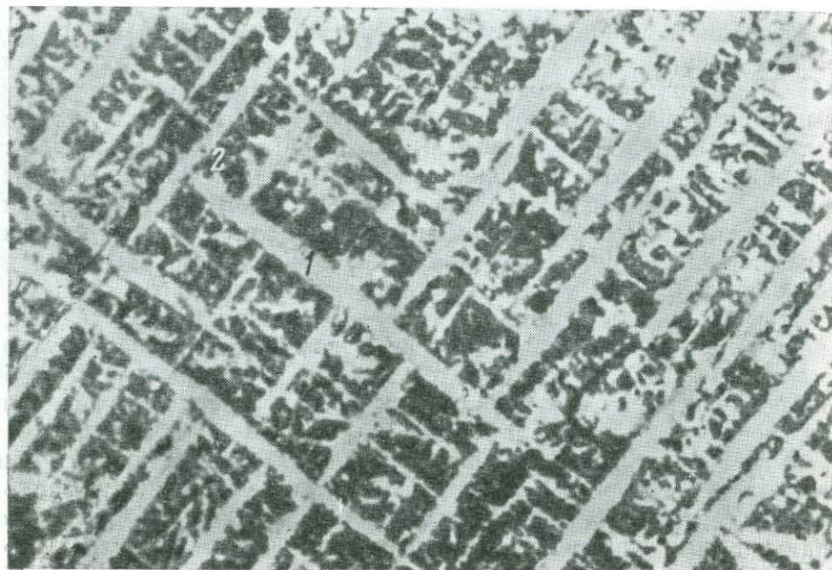
39. Распад тонкодисперсной смеси сульфидов железа и меди (черное) на халькопирит (1) и пирит (2). Комсомольское месторождение. Отраженный свет, увел. 1680
