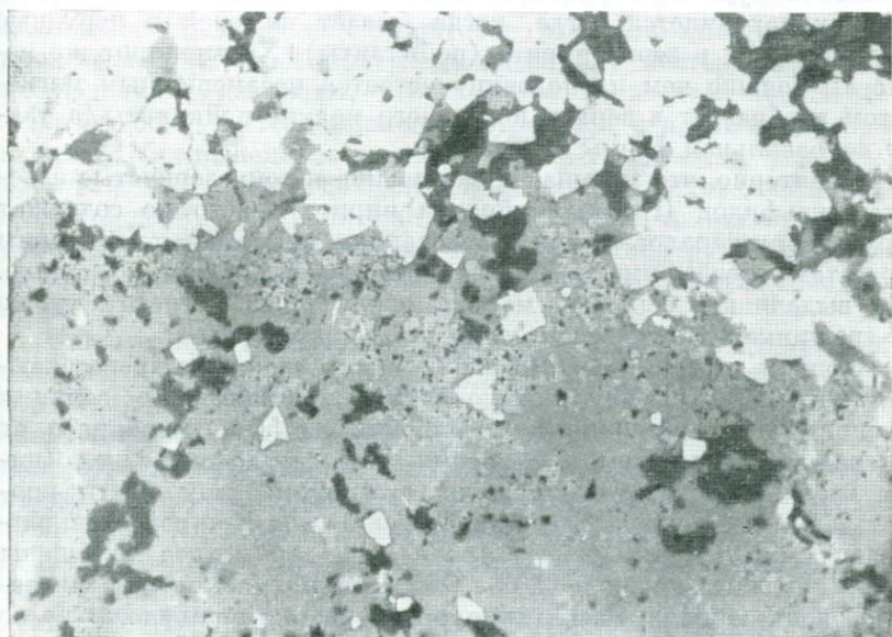
100. Избирательное замещение сфалерита (серое) магнетитом (светло-серые мелкие идиоморфные зерна); белое — пирит, черное — нерудные минералы. Приорское месторождение. Отраженный свет, увел. 94
