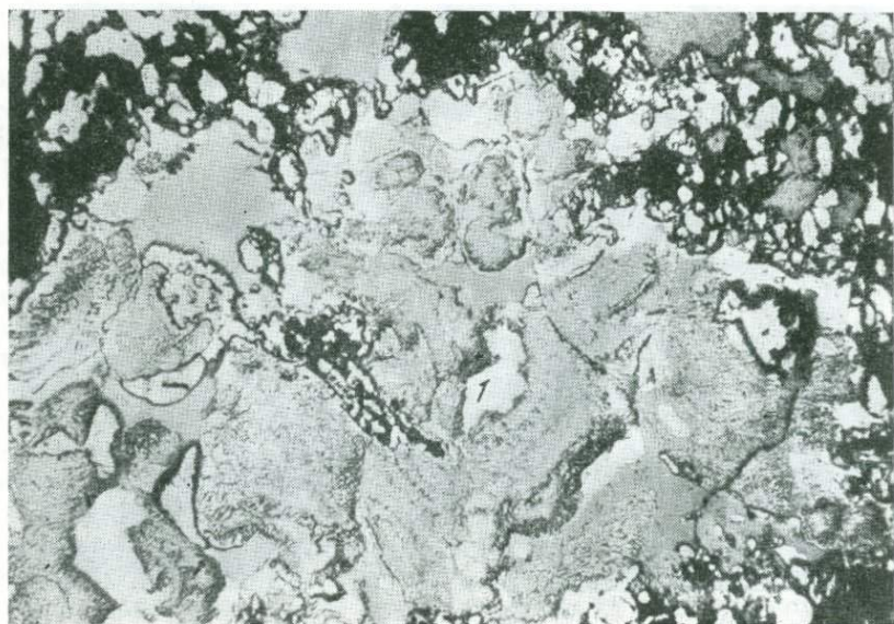
34. Частично распавшаяся смесь пирита (белые рельефные зерна), сфалерита (серое) и халькопирита (1); черное — пустотки и нерудные минералы. Комсомольское месторождение. Отраженный свет, увел. 70
