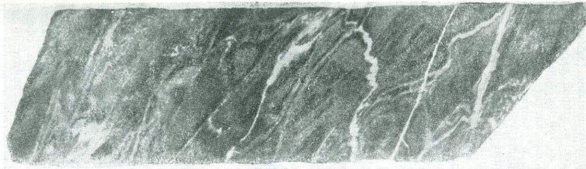
60. Пересечение руды (густая вкрапленность зерен пирита в кварцево-серицитовой породе) трещинами, выполненными непрозрачными кварцем и серицитом (белое). Зюзельское месторождение. Прицелированный керн
