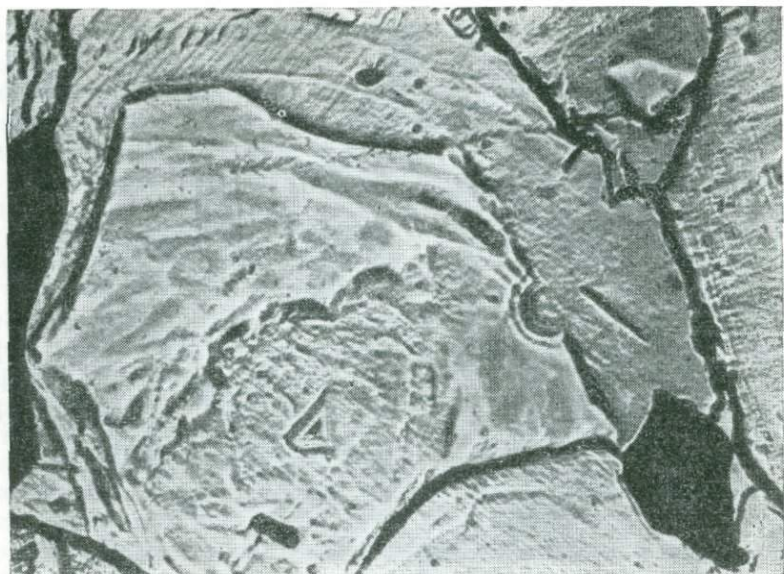
56. Исчезновение радиоактивного дворика в связи с проявлением спайности в зерне шрита. Карабаш. Отраженный свет, увел. 210
