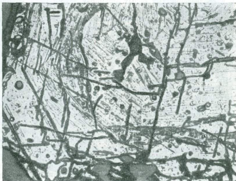
59. Радиоактивные дворики перекрывают зоны роста П в метакристалле пирита. Месторождение им. III Интернационала, Отраженный свет, протравлено, увел. 70 Черное — нерудные минералы
