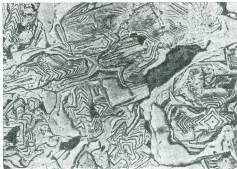
42. Деталь рис. 41. Псевдоморфозы пирита по марказиту, увел. 290
