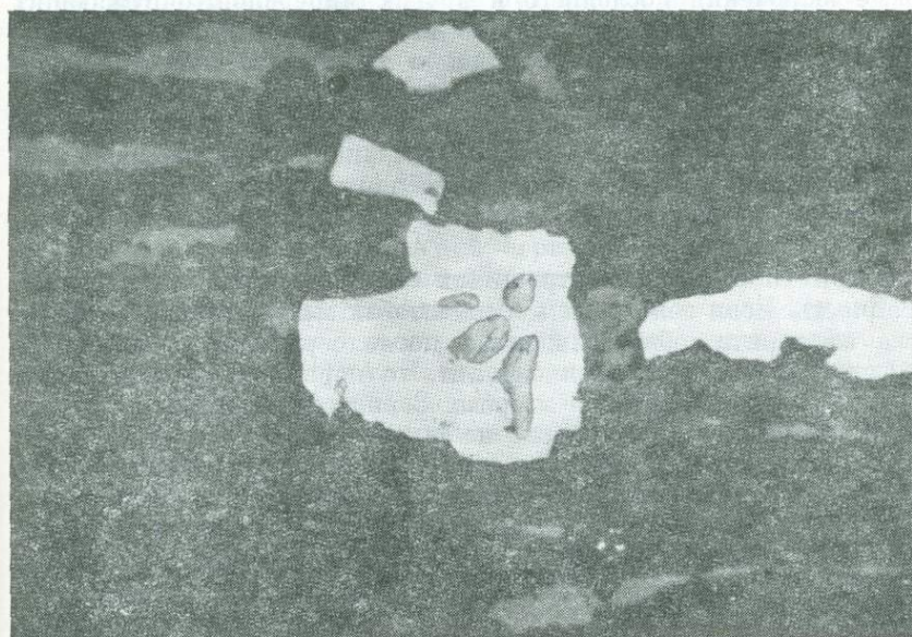
113. Сфалерит (серое) почти полностью замещен серицитом (черное); белое — пирит с пойкилитами сфалерита и халькопирита. Месторождение им. III Интернационала. Отраженный свет, увел. 120
