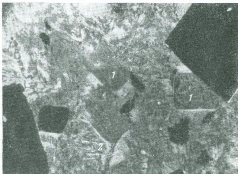
104. Псевдоморфозы (совершенные) крупночешуйчатого хлорита по идиоморфным зернам пирита (черное). Зюльское месторождение. Проходящий свет, без анализатора, увел. 130. Фото автора и Ф. П. Буслаява
