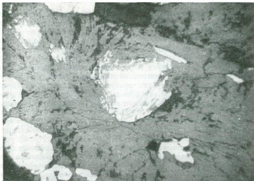
96. Замещение пирита (белое) магнетитом (серое); черное — нерудные минералы. Зюзельское месторождение. Отраженный свет, увел. 125
