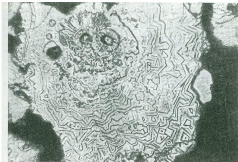
15. Перекристаллизация агрегата мелких колломорфных обособлений пирита в агрегат резко зональных зерен этого же минерала. Комсомольское месторождение. Отраженный свет, протравлено, увел. 675
