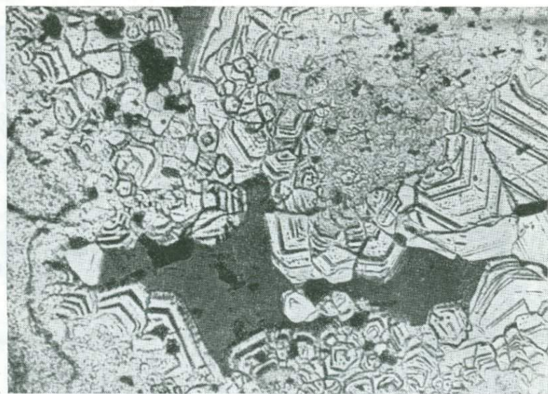
24. То же, что на рис. 23. Южное месторождение (Карабаш). Отраженный свет, протравлено, увел. 35
