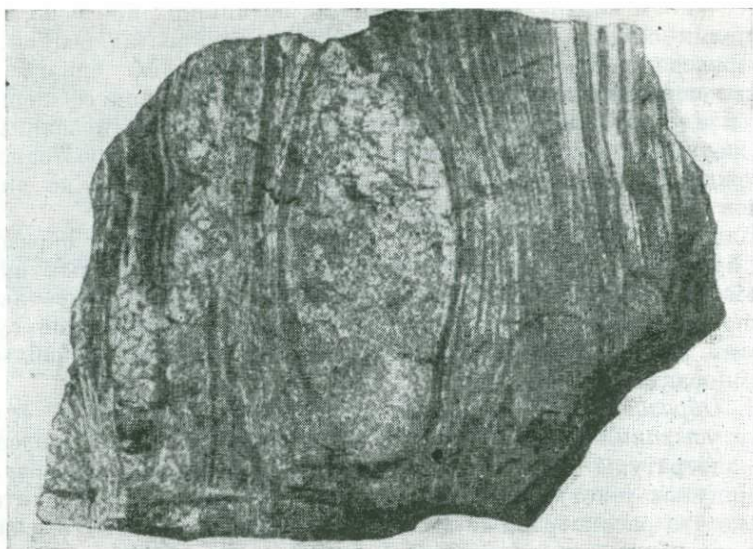
10. Обтекание пирит-сфалеритовой рудой линзообразных обломков серного колчедана (центр фото). Южное месторождение (Карабаш). \frac{1}{5} натур. вел.
