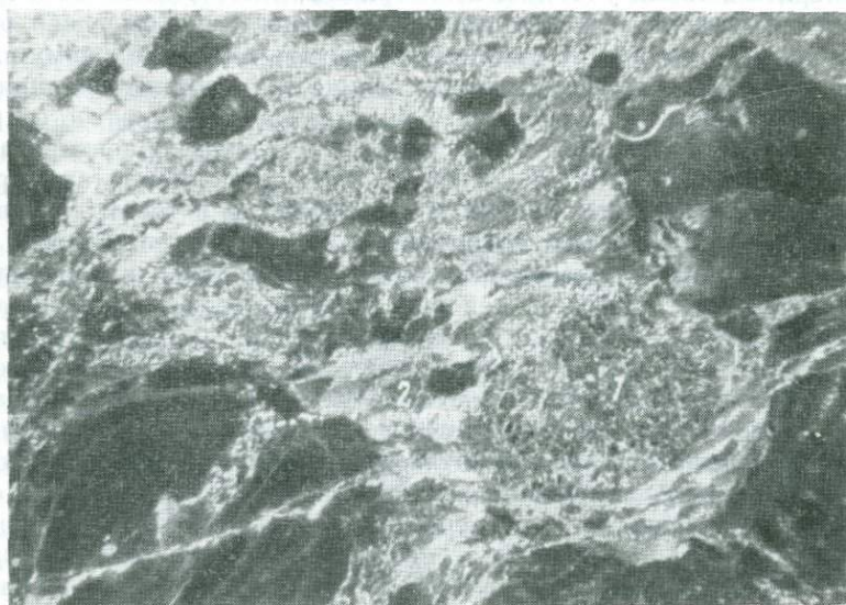
102. Псевдоморфозы мелкозернистого пирита (1) по крупным зернам сфалерита (черное), 2 — серицит. Месторождение им. III Интернационала. Полированный шлиф, снято под бинокулой, увел. 15
