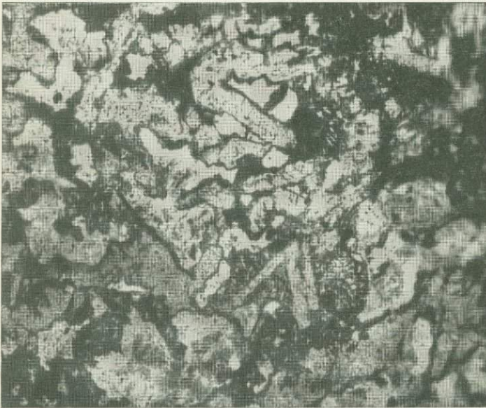
Ф и г. 23. Реликтовая офитовая микроструктура латеритного боксита, рудопроявление Кредиковское. Прозрачный шлиф, увел. 60, без анализатора
