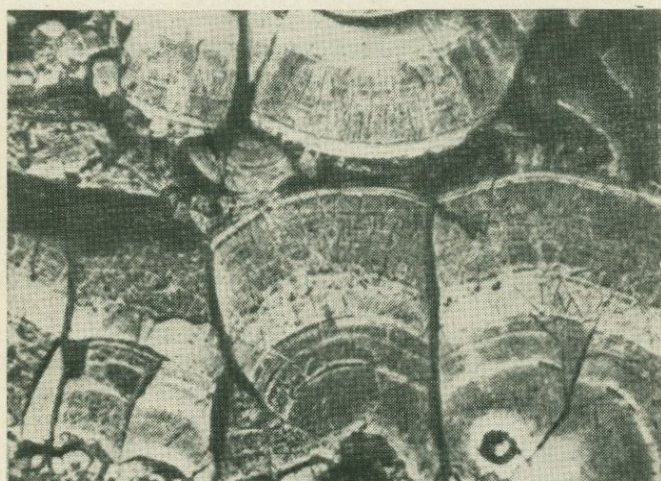
Рис. 29. Концентрически-зональные почки урановой смолки. Протравлено в HNO_3 . Полированный шлиф. Увел. 250 [233]
