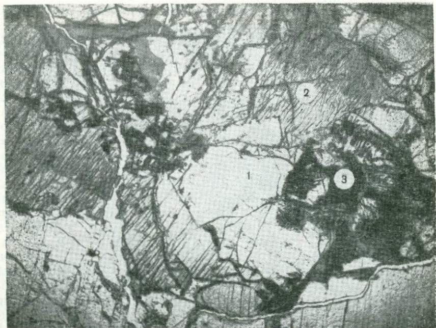
Рис. 26. Реакция анортита (1) с оливином (2) с образованием граната и шпинели (3) (шлиф при одном николе, \times 27 , вулкан Жупановский)
