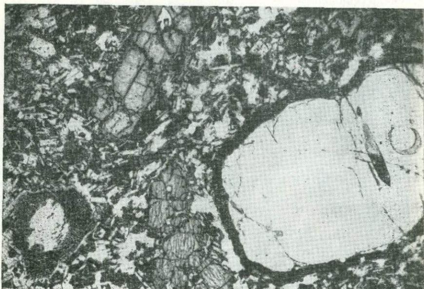
Рис. 29. Оторочка из клинопироксена вокруг зерна кварца (шлиф при одном николе, \times 25 , Анаунская вулканоструктура)
