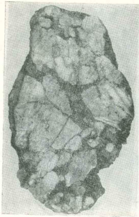
Рис. 51. Катаклазированная такситовая анортит-диопсид-оливиновая порода ( \times 1,2 , вулкан Ксудач) с участками локального плавления диопсида, которые фиксируются крупными воронкообразными макропорами
