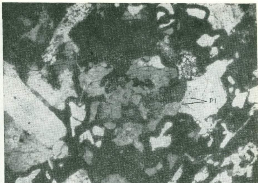
Рис. 19. Начальная стадия плавления гранита ( t=950^{\circ}\text{C} ): темное — стекло (L), светлое — плагиоклаз (Pl), кварц и калишпат (шлиф при одном никеле, \times 25 )
