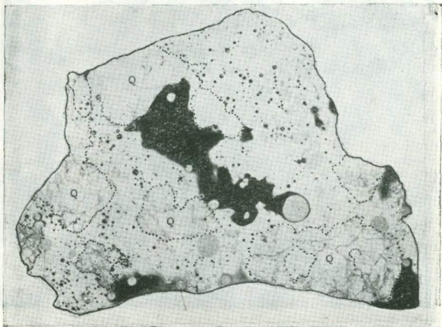
Рис. 20. Гранит при t=1150^{\circ}\text{C} после 41 ч плавления. Темное стекло на месте листочков биотита, светлое — на месте полевых шпатов, в расплаве сохраняются лишь кристаллы кварца (Q) (шлиф при одном никеле, \times 5 )
