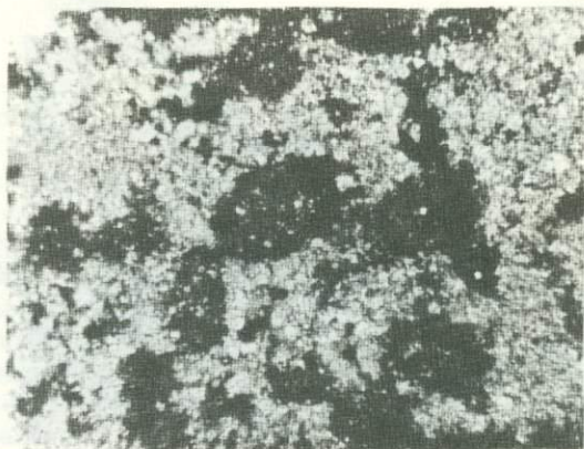
Рис. 22. Доломит мелкозернистый, со вторичными порами выщелачивания. Средний триас. Площадь Чограйская, скв. 1, глубина 3564–3565 м. Николи ||, увел. 120
