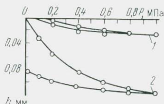
Рис. 90. Тарировочная кривая компрессионного прибора с применением стальной болванки (1) и бумажных фильтров, смоченных в воде (2)
