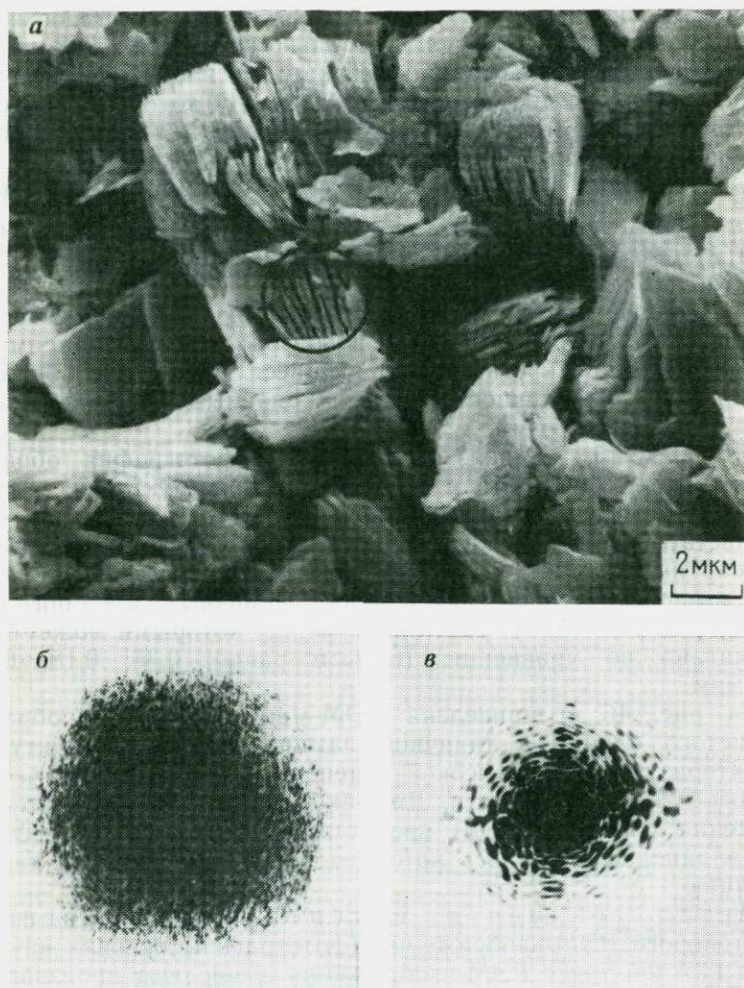
Рис. 45. РЭМ-микрофотография (а) и оптические дифракционные картины всего снимка (б) и отдельного микроагрегата (в) образца эллипального каолинита
