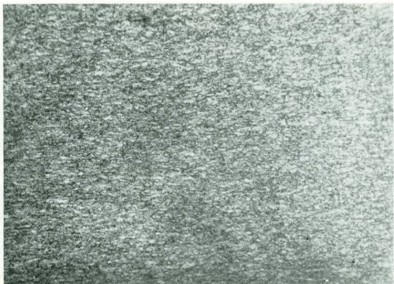
Рис. 1. Мраморизованный, частично рассланцованный известняк. \times 20 . Ник. +
