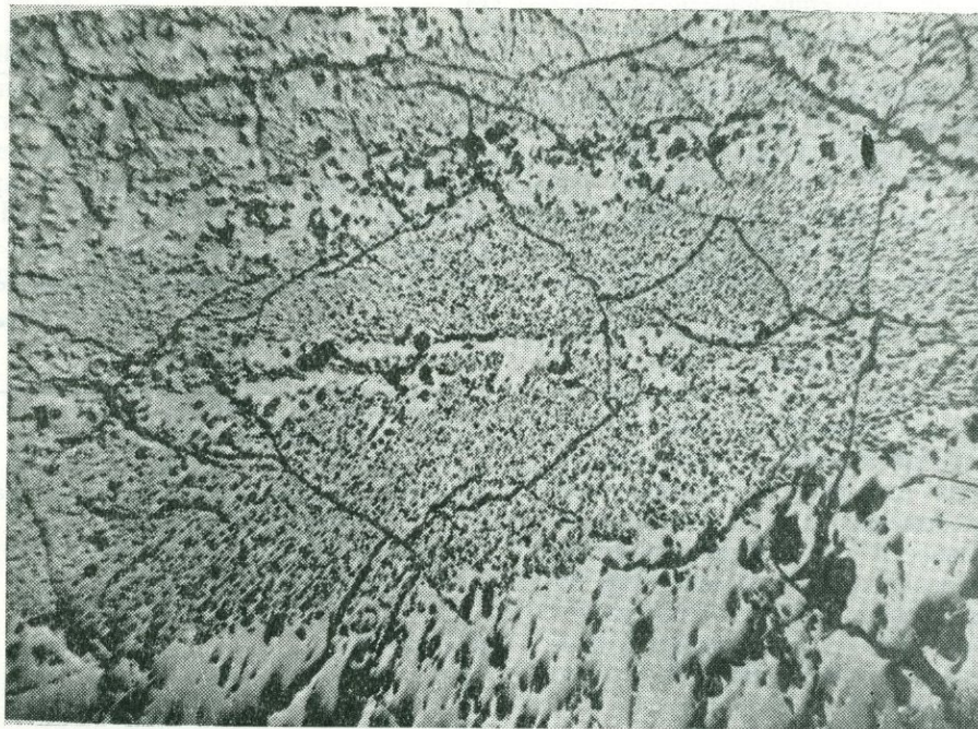
Рис. 3. Аншлиф образца М — 33 (магномнетит) под микроскопом, \times 40 .
