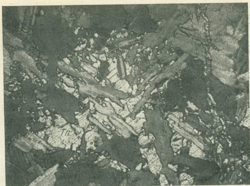
Фиг. 4. Скелетный кристалл топаза ( Tn ) в альбитизированном граните. Увел. 72, с анализатором
