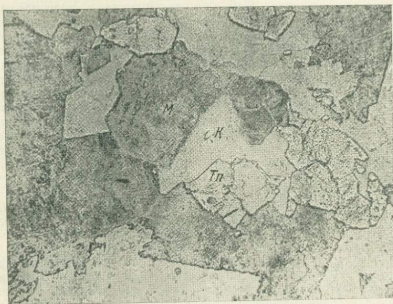
Фиг. 5. Короткопризматический топаз ( Tn ) в грейзенизированном аляскитовом граните, К — кварц, М — микроклин. Увел. 72, без анализатора
