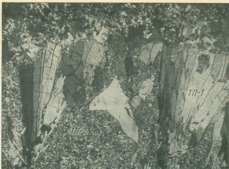
Фиг. 7. Радиально-лучистые кристаллы длиннопризматического топаза ( Tn-1 ) в агрегате тонкозернистого топаза ( Tn-2 ). Увел. 30, с анализатором
