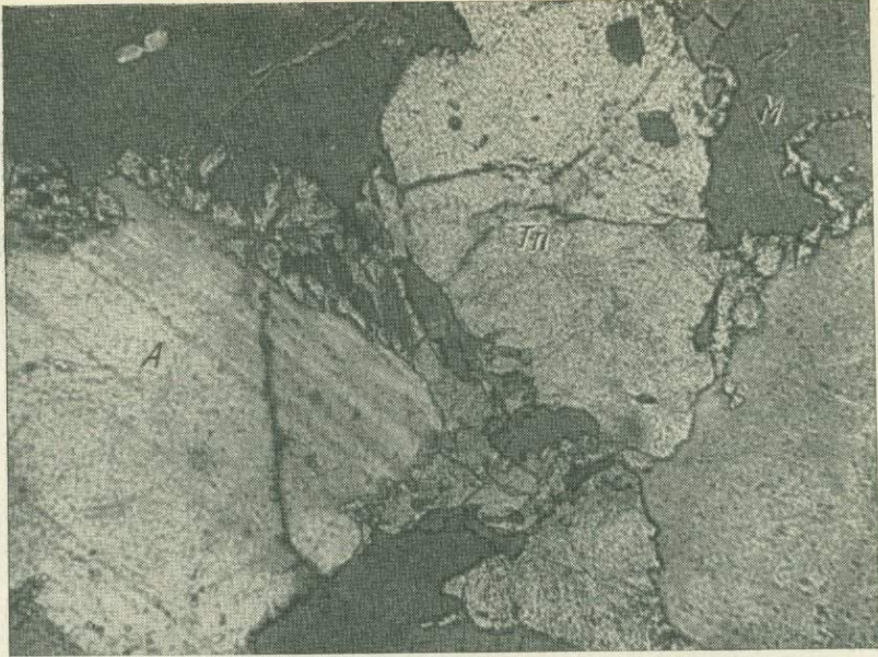
Фиг. 2. Короткопризматический топаз ( Tn ) на стыке кристаллов альбит-олигоклаза ( A ) и микроклина ( M ) в слабо грейзенизированном биотитовом граните. Увел. 72, с анализатором
