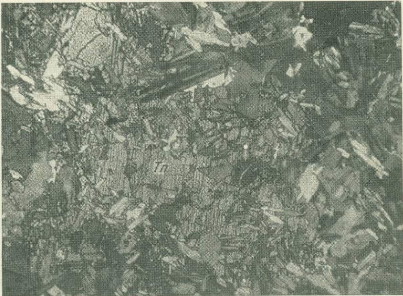
Фиг. 3. Ячеистый кристалл топаза ( Tn ) в альбитизированном граните. Увел. 30, с анализатором
