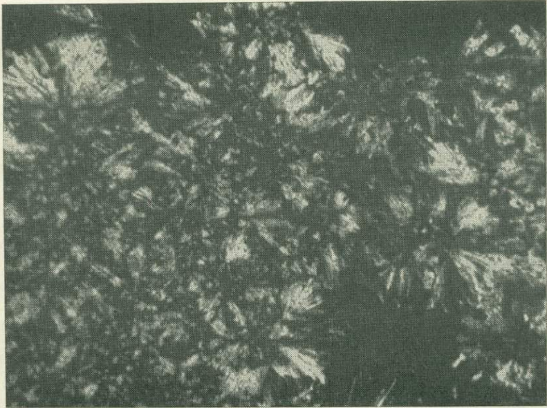
Фиг. 9. Агрегат волокнистых и сферолитовых кристаллов топаза (светло-серое). Флюорит — черное. Увел. 160, с анализатором
