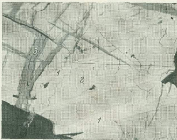
Рис. 50. Пластинчатые и веретенообразные выделения пентландита-1 в халькопирите.
