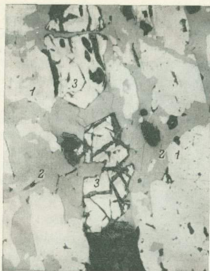
Рис. 65. Частичное замещение ильменита-3 сфеном.
