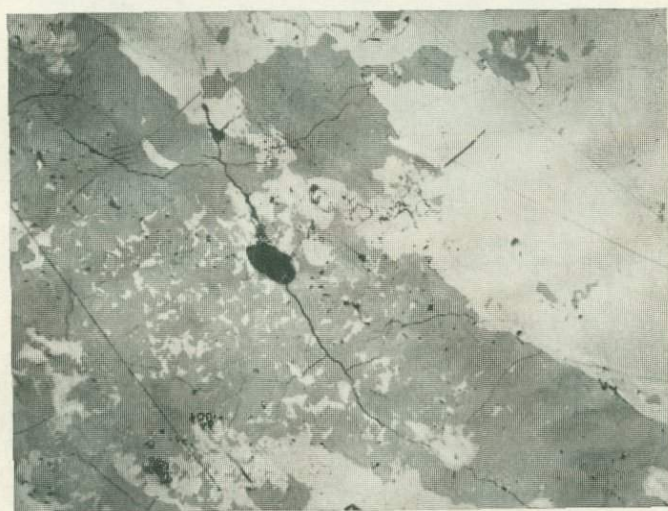
Рис. 45. Обособления тонкозернистого пирротина (темно-серое).
