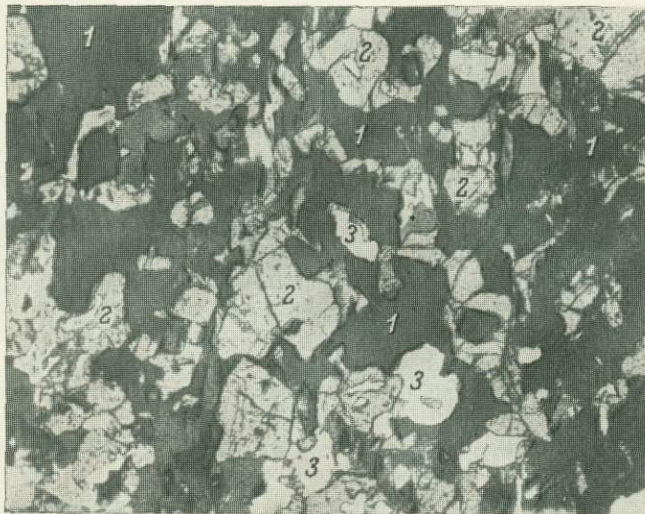
Рис. 18. Околорудная кварц-амфибол-гранатовая порода. Роговая обманка (1) цементирует зерна граната (2) и кварца (3). Шлиф, при одном никеле, увел. 30.
