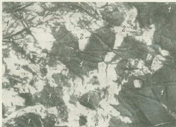
Рис. 86. Замещение оливина (1) мелкозернистым актинолитом (2).
