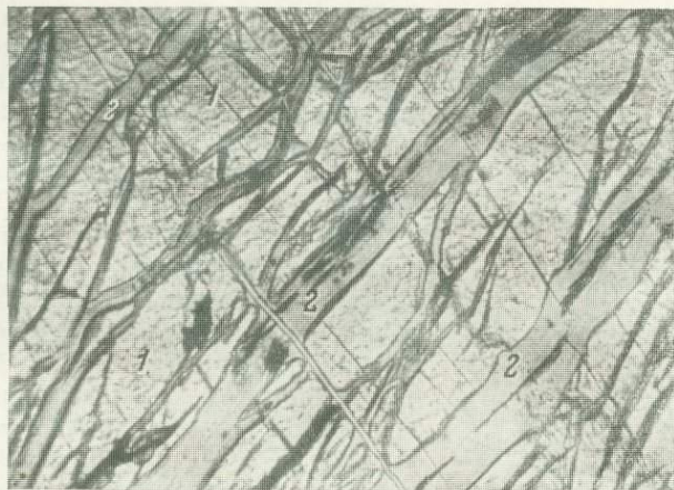
Рис. 90. Пересечение бронзита (1) прожилками серпентина (2).
