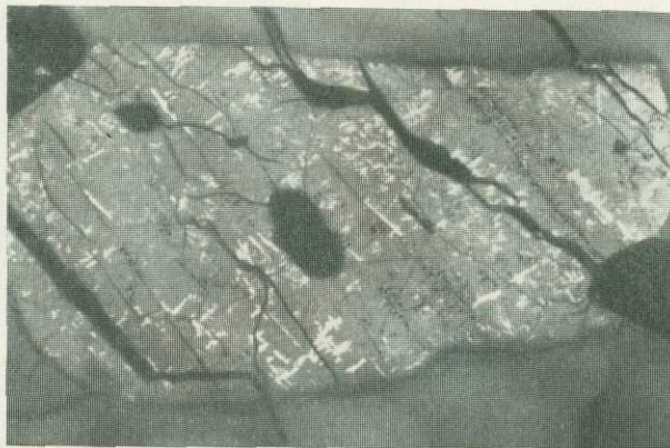
Рис. 53. Пластинчатые и дендритовидные вросстки малахита (белое и серое) в пентландите-1.
