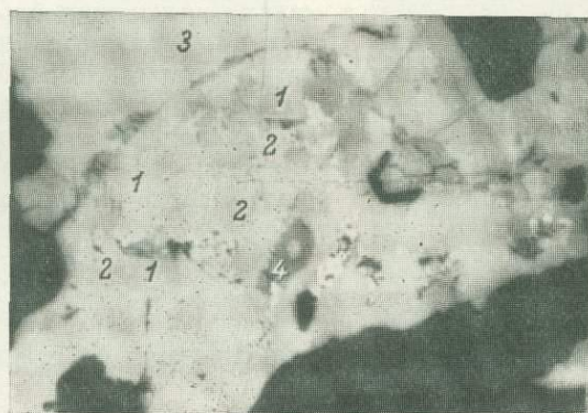
Рис. 79. Агрегат теллуридов в халькопирите.
