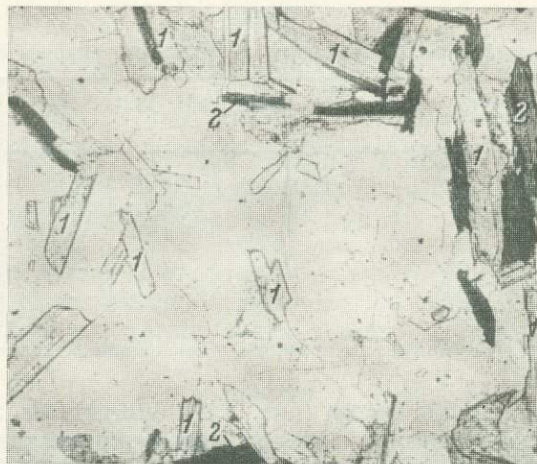
Рис. 113. Замещение биотита мусковитом в двуслюдяном гнейсе.
