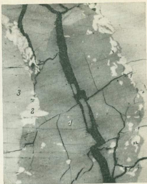
Рис. 44. Прожилочек «оливкового» пирротина с включениями пентландита.
