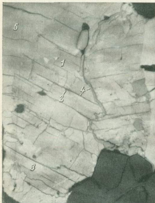
Рис. 49. Внутреннее строение троилита с включениями пентландита, халькопирита и магнетита-2.
