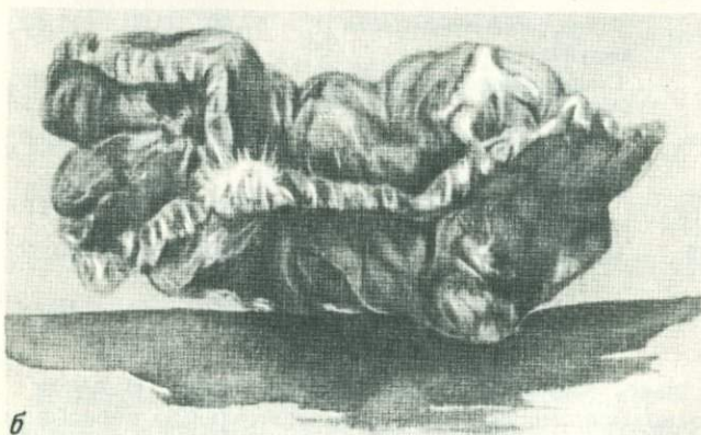
Рис. 4. Шлиф и штуфные образцы боксита и бокситосодержащих пород а-брекчиевидное строение охристо-глинистых пород бокситоносной фации, выполнявших карсты упинского известняка. Никитский участок Тульской области, увел. 20 с анализатором; б-прожилки гипбсита с бемитом, пересекающие охристо-глинистую породу бокситоносной фации. Шенуровский участок Тульской области, штуф в натур. вел.; в-гипбсит-бемит-галлуазит-каолинитовая порода бокситоносной фации. Шенуровский участок Тульской области. Штуф в натур. вел.
