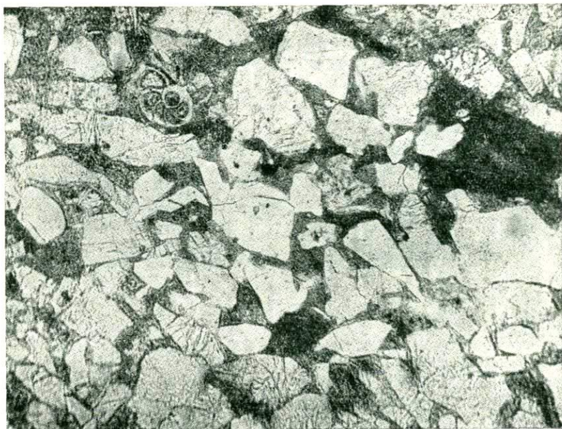
Рис. 18. Туффит кристаллокластический липарито-дацитового состава. Черное — пластинки биотита, наверху слева — раковина фораминиферы. Увелич. 30×, без анализатора. Свита горы Индюк (верхний аален), масловский горизонт, пачка флишoidного переслаивания. Руч. Скакуха
