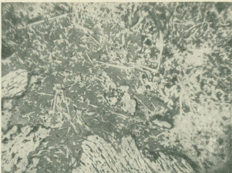
Рис. 9. Прожилки карбоната с тиллитом пересекают пиритовые руды (месторождение Оруро, Боливия). Увел. 65
