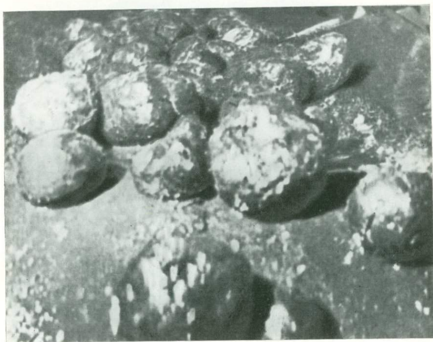
Рис. 52. Конкретии на конвейере после сепарации. Материалы фирмы «Дипси Венчурс» («Оушен Индастри», 1970).
