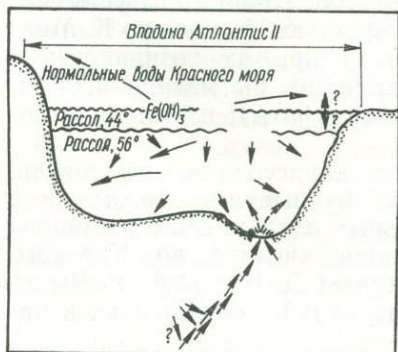
Рис. 60. Схема некоторых предполагаемых процессов осаждения минералов во впадине Атлантик II (по Д. Бишоффу, 1969).
