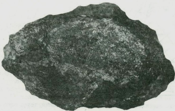
Рис. 3. Рудный обломок пирит-халькопиритового состава из межпластовой зоны смятия. Западный штрек 1 шт. 10. Нат. вел.
