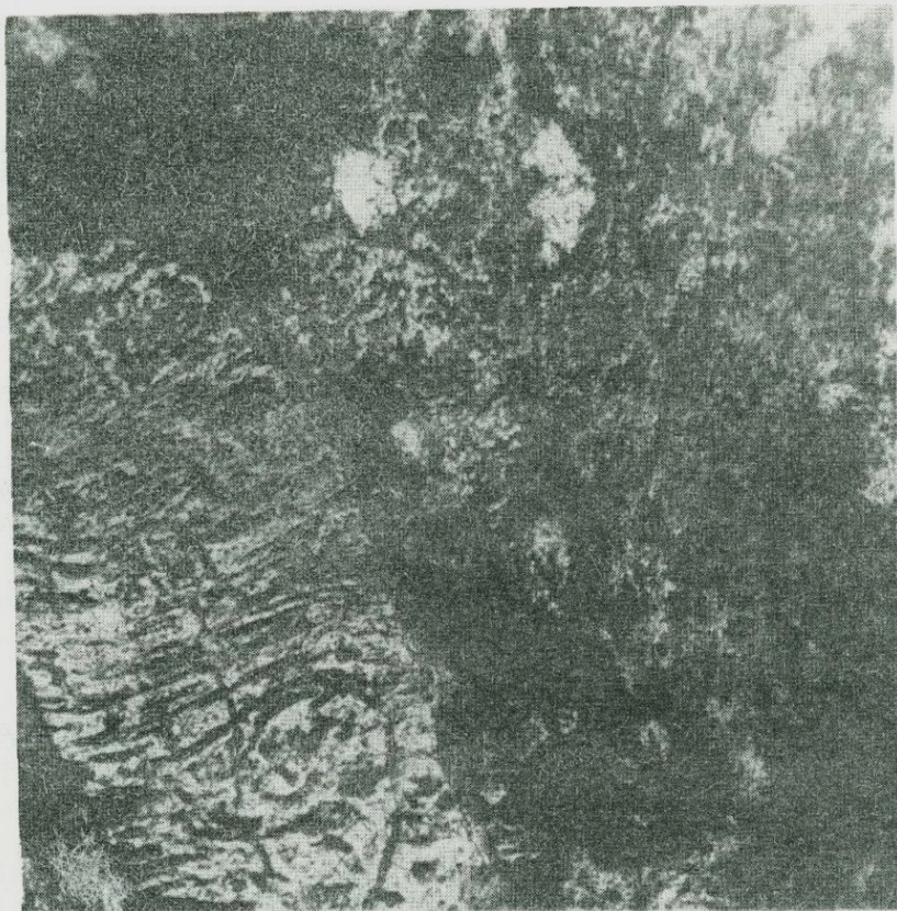
Рис. 4. Замещенный морденитом кристалло-витрокластический туф. Крупные обломки вулканического стекла с ленточно-параллельной, плейчатую-параллельной и перлитовой текстурами, превращены в полные псевдоморфозы морденита. Увелич. 100, ник. П.
