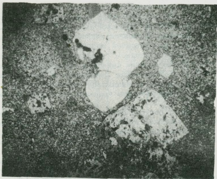
Рис. 2. Гранит-порфир. Два поколения вкрапленников кварца и плагиоклаза, частично резорбированных основной массой; шл. 665, 35 х; ник. +
