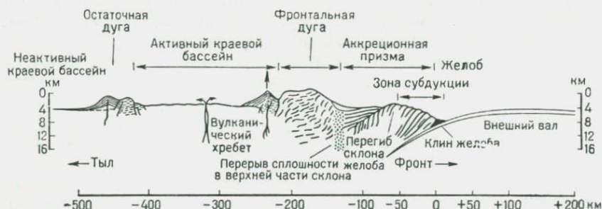
РИС. 9. СХЕМА СТРОЕНИЯ ОСТРОВНОЙ ДУГИ (ПО КАРИГУ И ШЕРМАНУ, 1975). ВЕРТИКАЛЬНЫЙ МАСШТАБ УВЕЛИЧЕН В ПЯТЬ РАЗ
