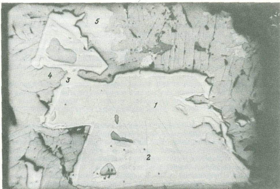
Р и с. 8. Срастание станнопаладинита Pd_6Sn_3Cu_1 (1), платинистого атокита (Pd, Pt)_3Sn (2) и ферроплатины (3) среди кубанита (4) и пентландита (5). Полир. шлиф, увел. 90
