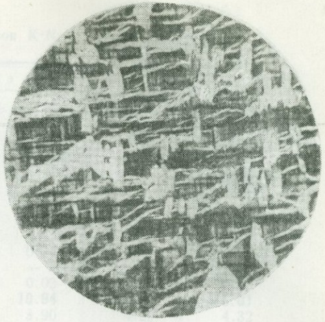
Фиг. 2. Микроклин-пертит. Микроклиновая решетка. Шнуровидные вроски альбита по (001) и более крупные пятна Аб с шахматной структурой. Разрез по (001)
