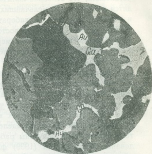
Фиг. 2. Золото (Au) и галенит (Ga) в тесном сростании располагаются между зернами сфалерита (Sl). Черное — кварц. Айдырлинское месторождение, жила Миасская, 4 гор. \times 85
