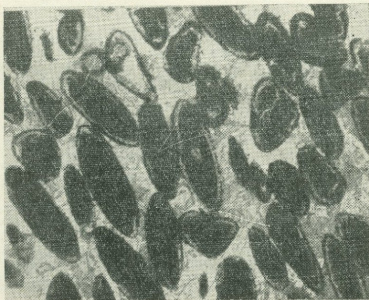
Рис. 18. Оолитовая структура. Оолиты доломита замещены гематит-магнетитовым агрегатом. Маньзинское м-ние. Аншлиф. Ув. 9. Без анализатора
