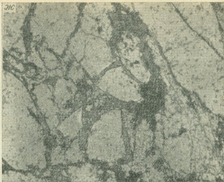
Рис. 16. Структуры магномангнетитовых руд, Тагарское м-ние. Аншлифы. Без анализатора
